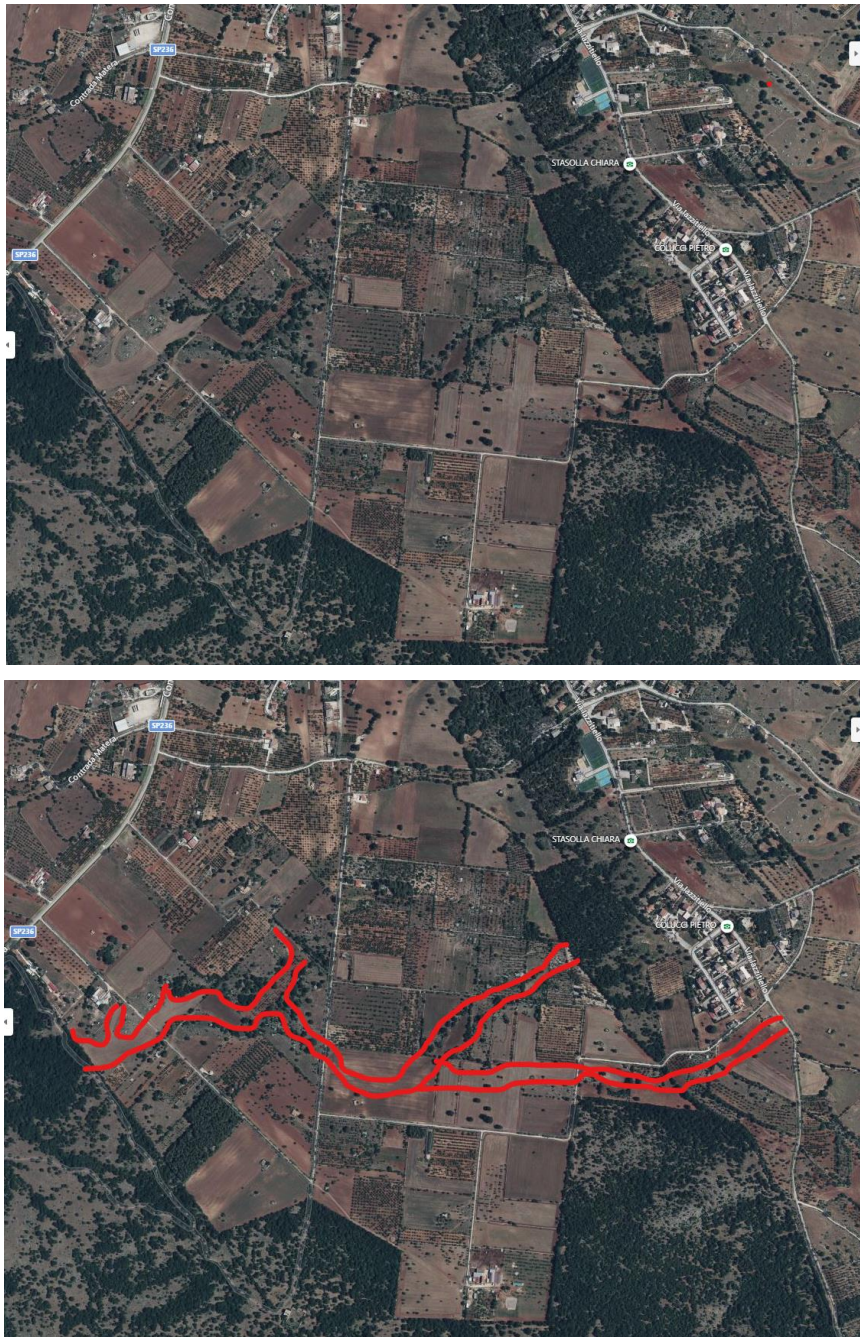
Figura 1: area a sud di Santeramo in Colle ove sono riconoscibili dei paleoalvei da foto area
