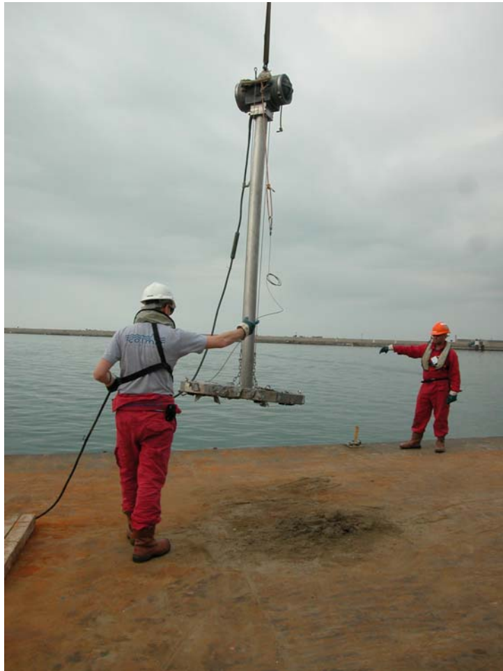
Figura 5 – Vibrocarotiere Rossfelder, modello P-3C, manovrato per mezzo di gru.
