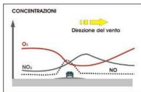
Figura 12 - Andamento qualitativo della concentrazione di NO, NO 2 e O 3 nella sezione di una strada
