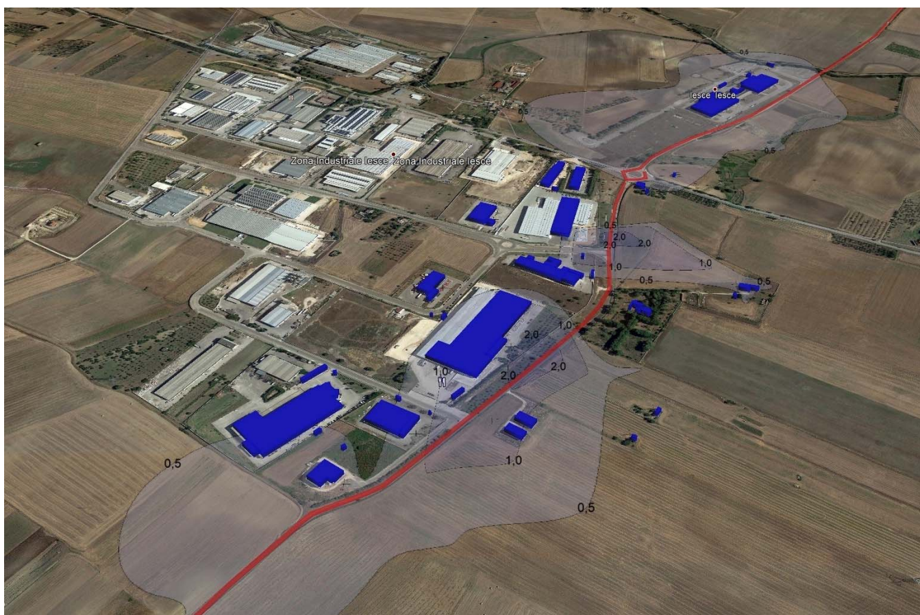
Figura 27 – Modellazione nuvola di propagazione 3D (scenario al 2040) importata su Google Earth (CO)
