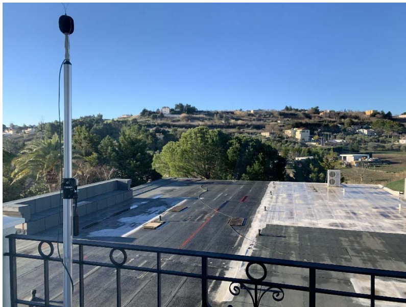
Figura 5 – Centralina di monitoraggio acustico da traffico ferroviario c/o Hotel La Corte
