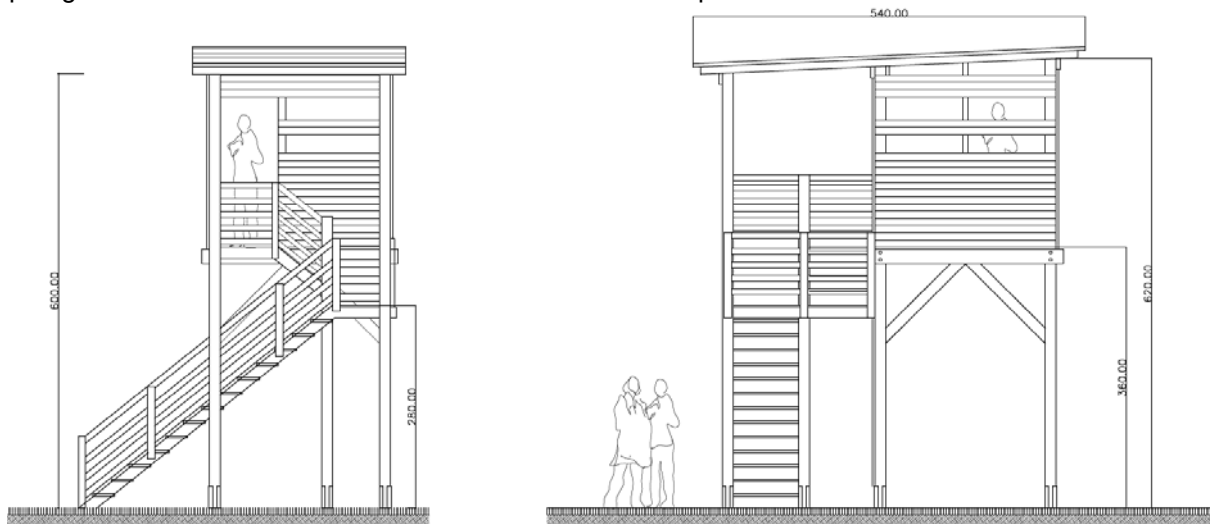
Figura 5-11 Realizzazione "torretta" di avvistamento della fauna locale per la pratica del "Birdwatching" all'interno dell'area di sosta prevista nella Rotatoria n.5
