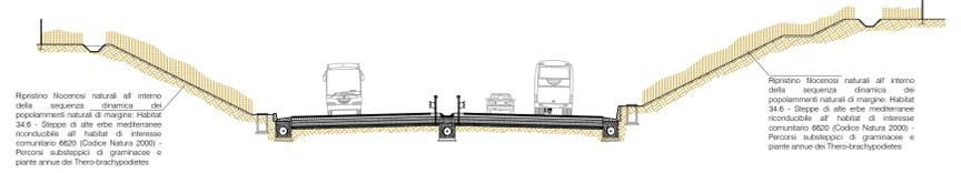
SEZIONE TIPO IN RILEVATO CON TOMBINO DI ATTRAVERSAMENTO FAUNISTICO
