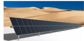
I Tracker sono composti da una parte fissa, ancorata al terreno mediante infissione di pali verticali (o altre soluzioni staticamente valide e adeguate al contesto e al terreno in cui dovranno essere ubicate) e una parte mobile ad essa ancorata sulla quale sono posizionati i pannelli fotovoltaici.
