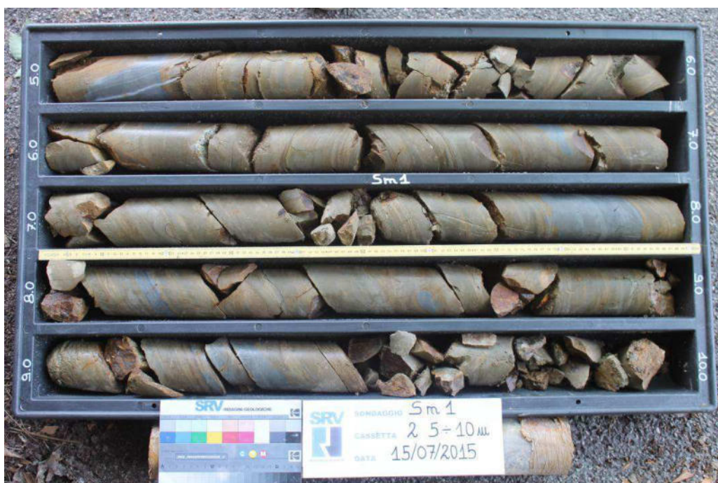
Foto n° 54: Sondaggio Sm1, Cassetta 2: da 5.0 a 10.0 metri.
