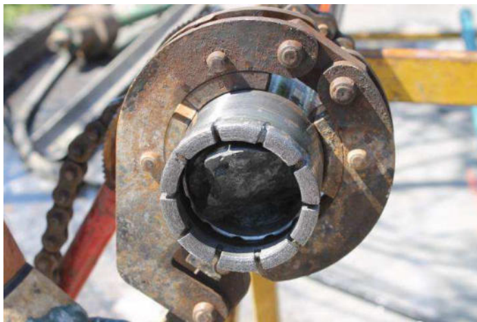
Foto n° 3 – Carotiere doppio T6 con corona diamantata (fase apertura carotiere).
