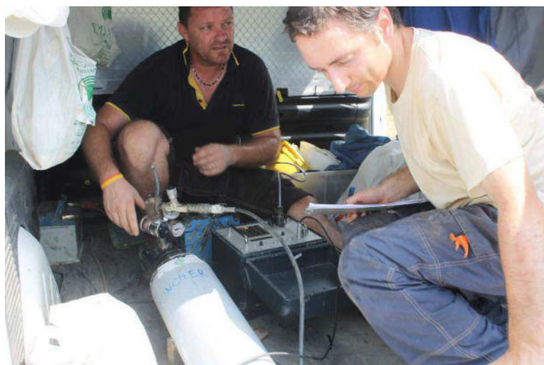
Foto n° 8 – Esecuzione Prova Dilatometrica: strumentazione e centralina di acquisizione.
