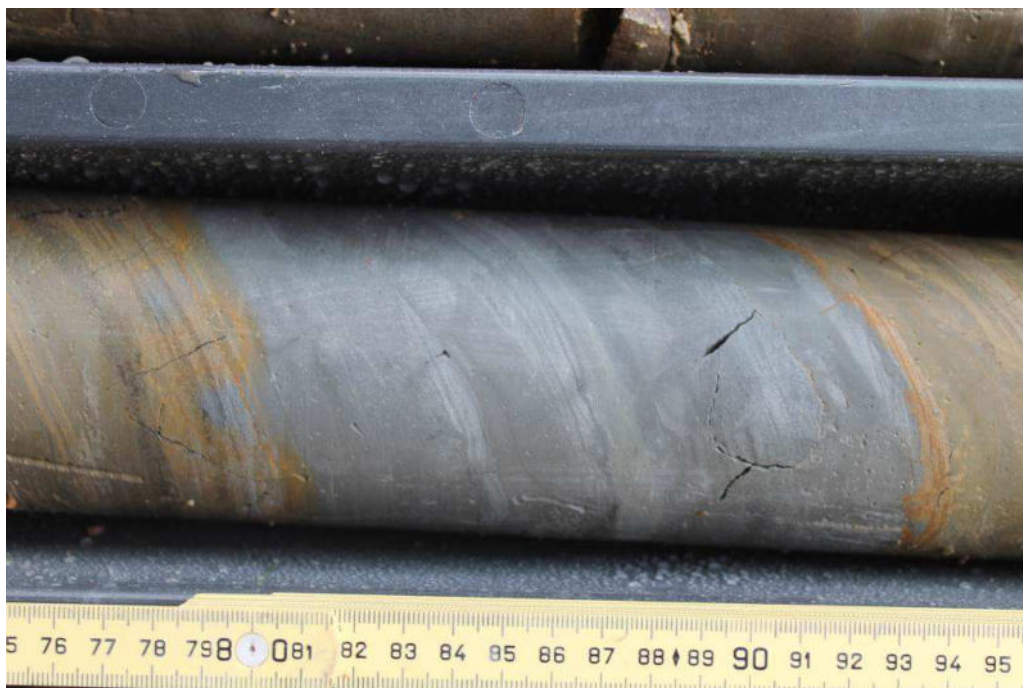
Foto n° 56: Sondaggio Sm1: arenarie a grana fina laminate e con impronte di fondo, con passaggio graduale a peliti (parte centrale della carota), con passaggio a livelli ossidati ed alterati.
