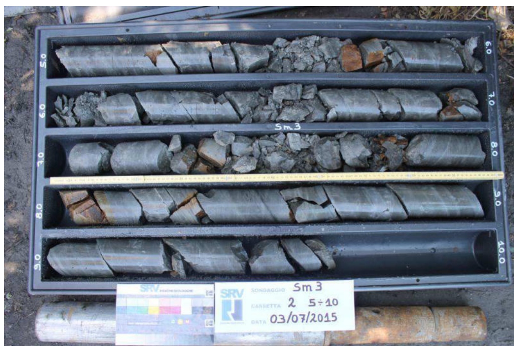
Foto n° 60: Sondaggio Sm3, Cassetta 2: da 5.0 a 9.6 metri.
