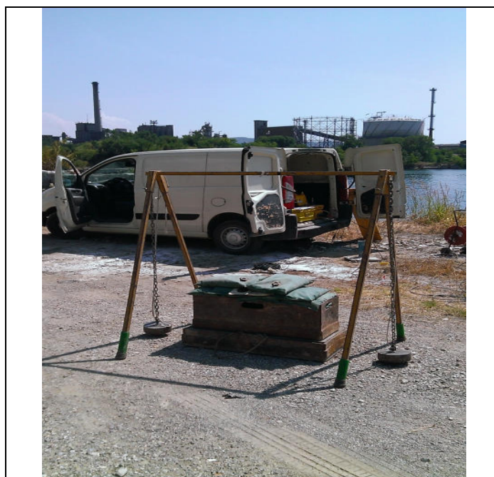
Fig. 5.2 – Il dispositivo di energizzazione utilizzato per le prove down-hole.
