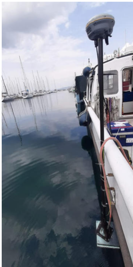
Foto - Sistema GNSS Trimble R8s e trasduttore SBP Innomar Smart
