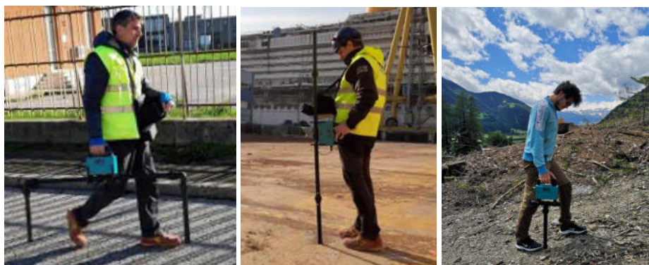
Immagine 13, 14, 15 - Esempio di acquisizione con metodo orizzontale, metodo verticale a due antenne e con metodo ad antenna singola
