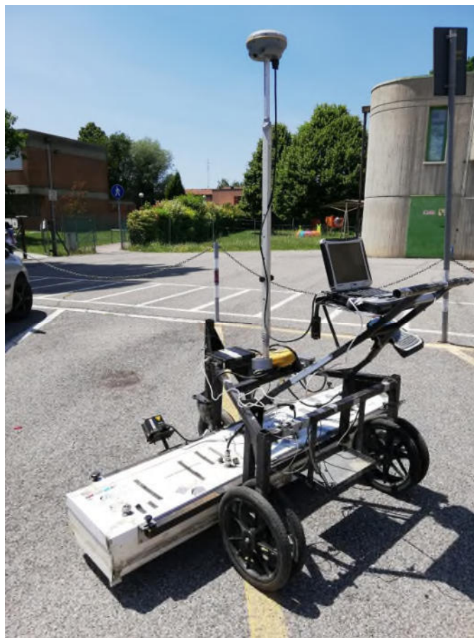
Immagine 16 - Radar multicanale IDS STREAM-X a 16 canali a freq. 200 MHz
