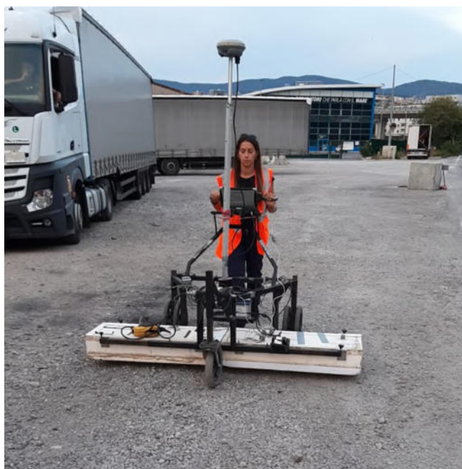
Foto - Esecuzione del rilievo georadar multicanale con IDS Stream X
