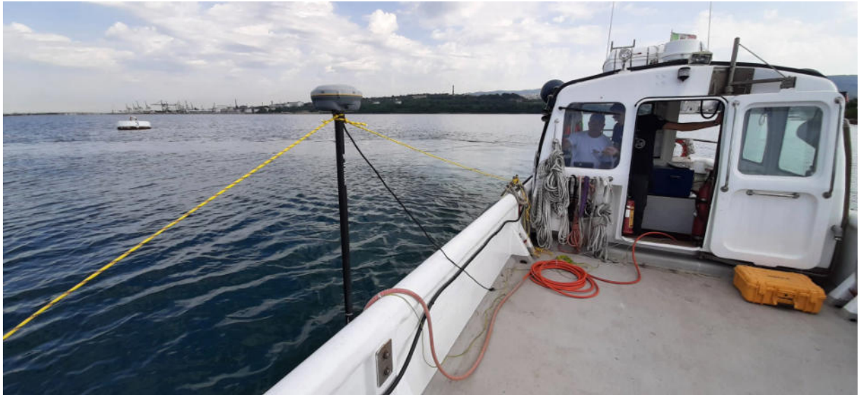
Foto - Sistema GNSS Trimble R8s
