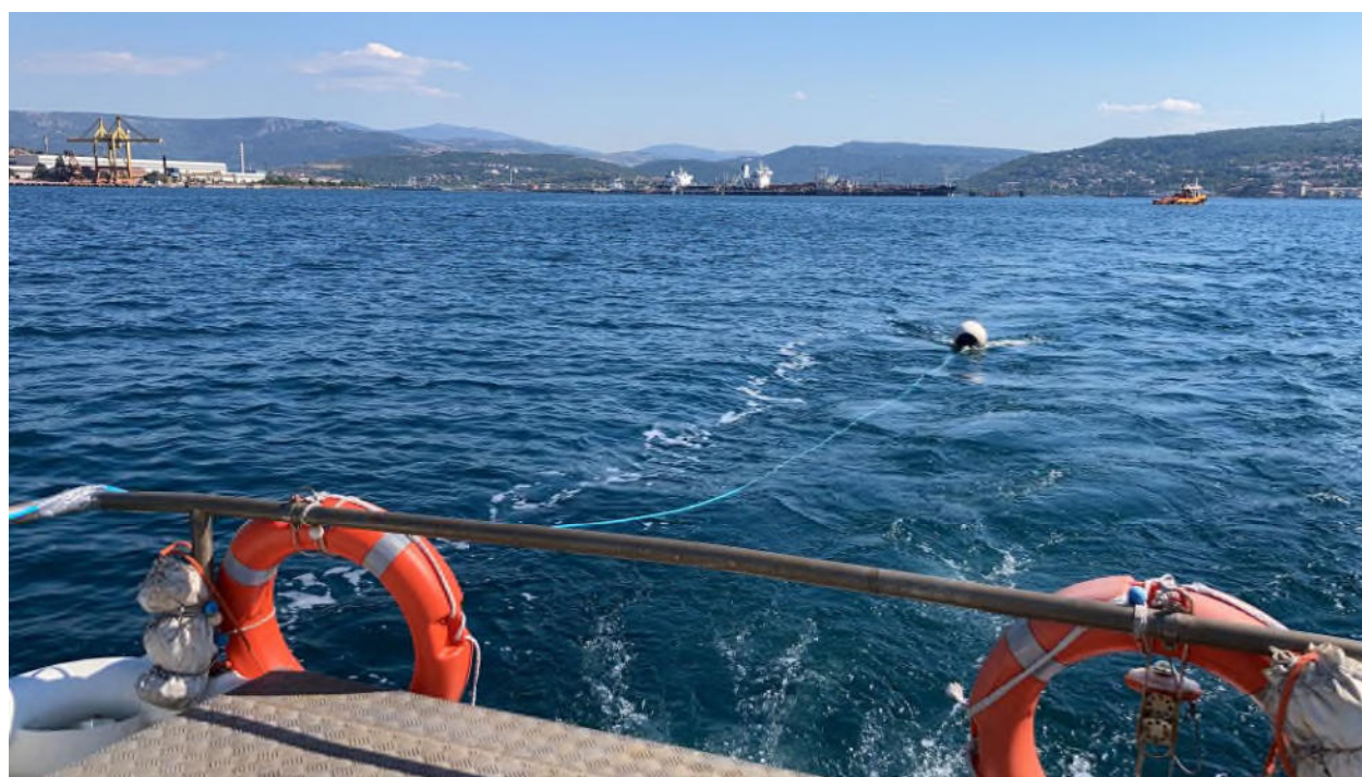
Foto - Esecuzione rilievo con magnetometro marino
