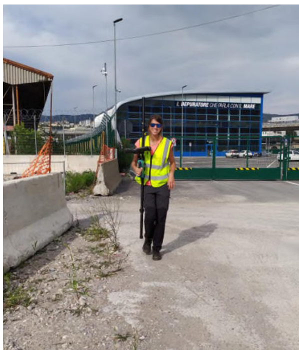
Foto - Esecuzione del rilievo elettromagnetico con strumentazione EMFAD VLF
