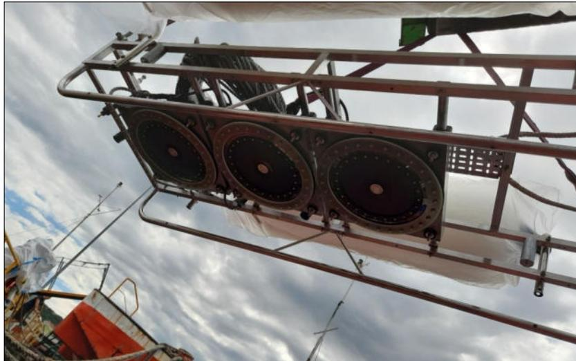
*Figura A.2.3 - La sorgente S-boom composta da 3 trasduttori AA252.*
