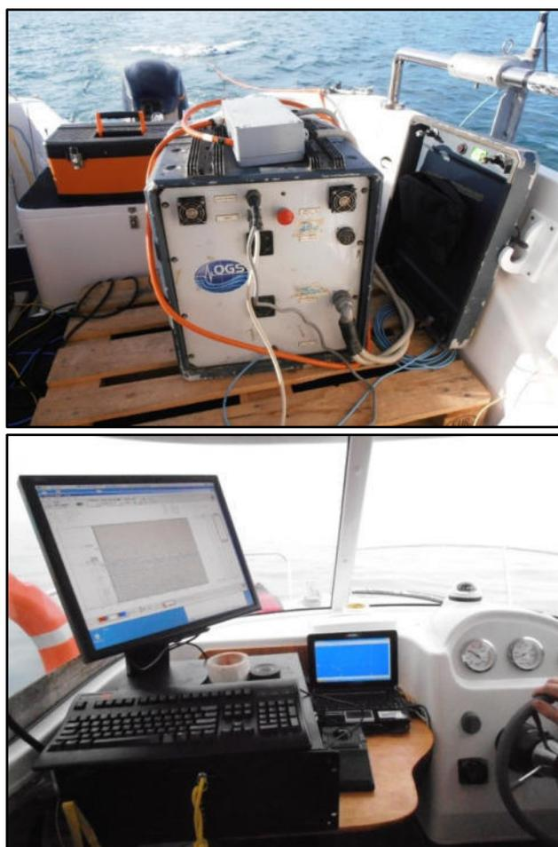
*Figura A.1.2 A sinistra il Pulsar 2002 e a destra la postazione acquisizione - navigazione.*
