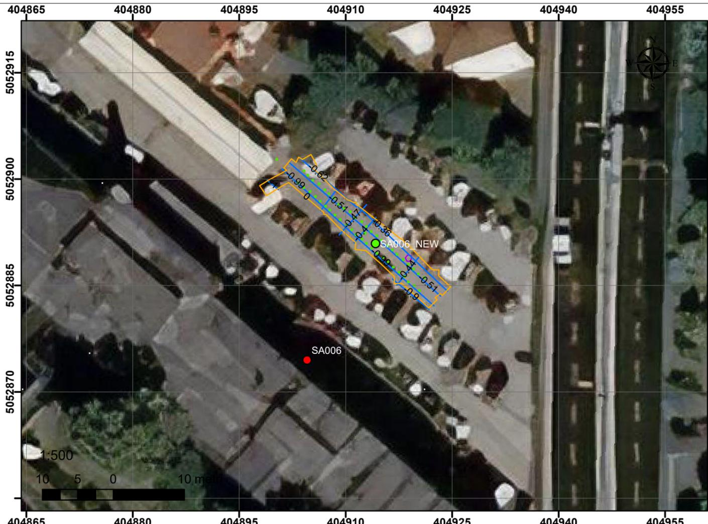
Nell'area di futura realizzazione del sondaggio SA006 la mappatura con il georadar ha permesso di identificare alcune strutture/bersagli sepolti (anomalie lineari, anomalie areali).
