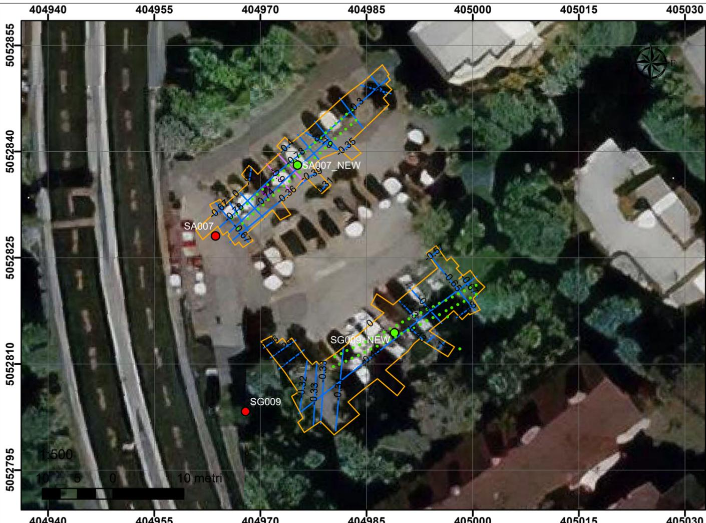
Nell'area di futura realizzazione dei sondaggi SA007 e SG009 la mappatura con il georadar ha permesso di identificare alcune strutture/bersagli sepolti (anomalie lineari, anomalie areali).
