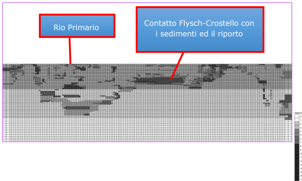
Figura 2-36: Sezione verticale della griglia dell'errore a 300 m dall'origine. Notare che a profondità maggiori corrispondono errori maggiori, particolarmente nelle aree del Rio Primario e del contatto tra il Flysch e Crostello con i sedimenti ed il riporto.
