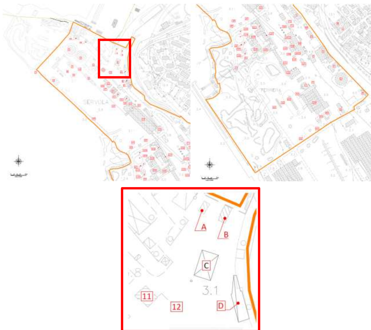
Figura 5-56 Estratto dalla tavola "PIANO DI DISMISSIONE Comprendenti anche le attività di smantellamento e demolizione dell'Area a Caldo Ferriera di Trieste", che riporta l'indicazione di tutti gli edifici da demolire. Nel riquadro rosso gli edifici mantenuti fino alla realizzazione del nuovo gate di accesso e degli altri edifici pubblici
