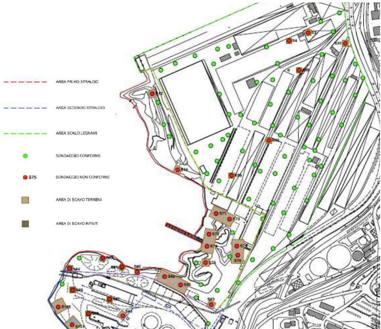
Figura 5-35 caratterizzazione condotta nello scalo legnami e nell'area della piattaforma logistica
