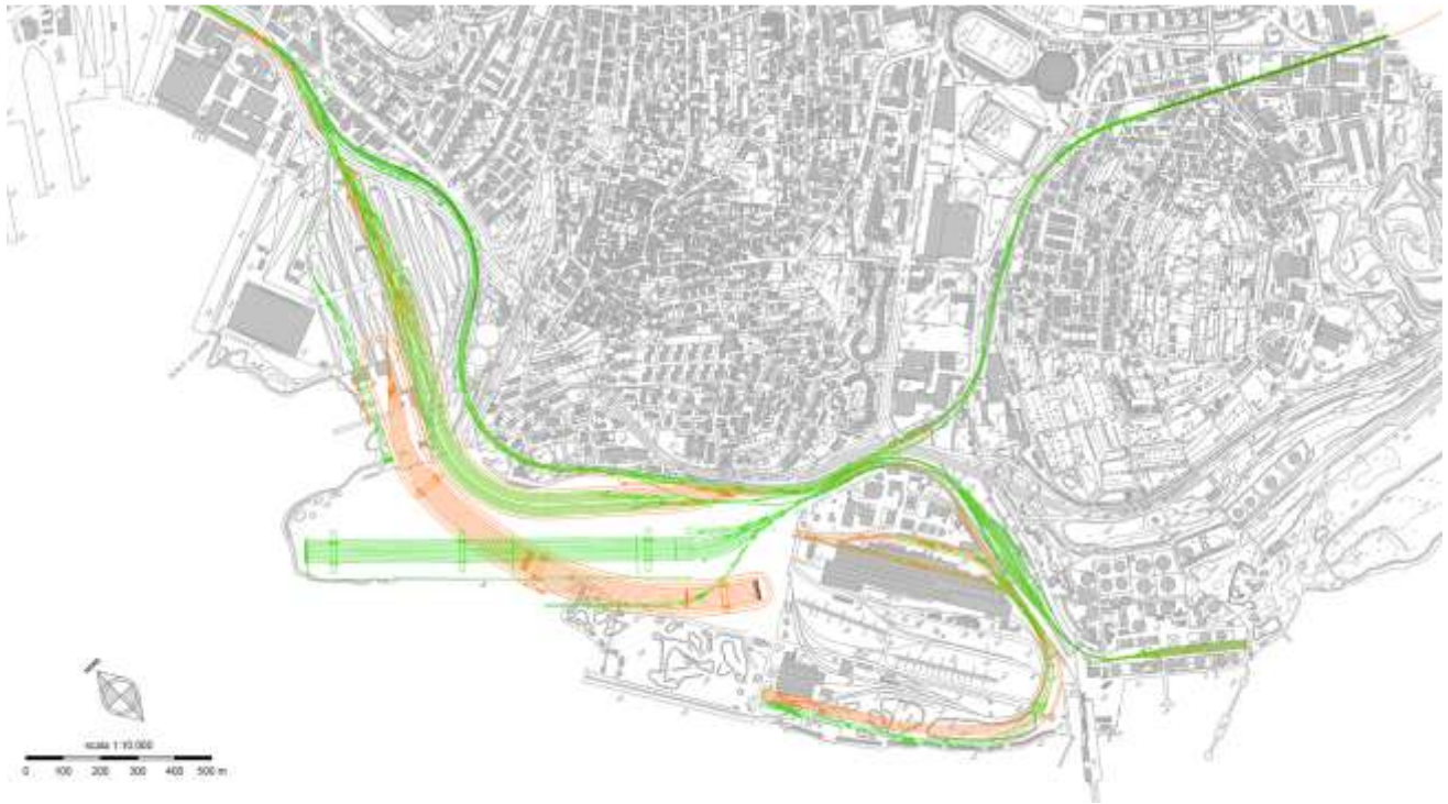
Figura 3-5. Sovrapposizione delle due alternative: in colore arancione la soluzione con asta di manovra lato Campo Marzio; in colore verde la soluzione con asta di manovra lato Aquilinia.
