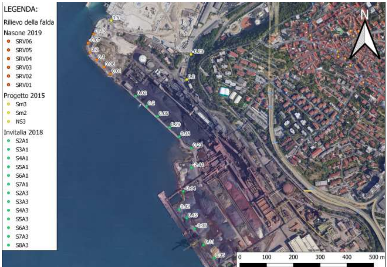
Figura 6-54 – Planimetria delle quote di falda registrate, su livello mare, nell'area d'interesse (sc. 5.000)
