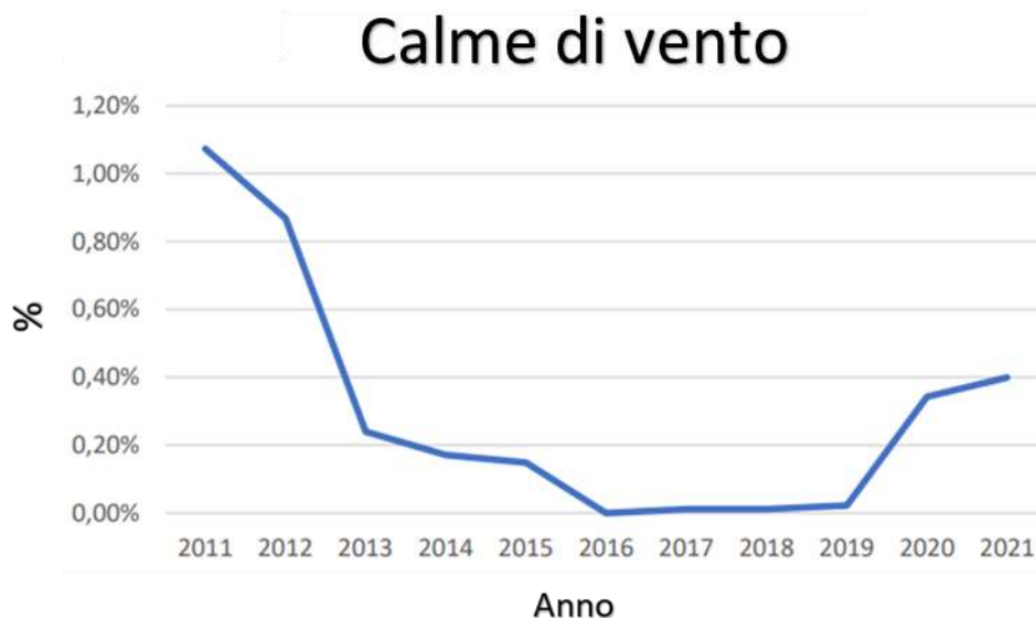
Figura 6-64 – Rappresentazione delle frequenze di calma del vento (velocità oraria del vento < 0.5 m/s) su base annua per il periodo di riferimento 2011-2021
