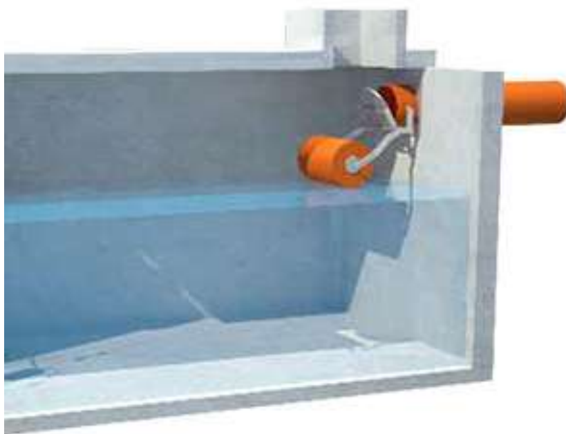
Figura 5-12 Schema di funzionamento della valvola a galleggiante
