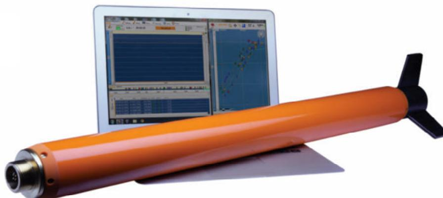
*Immagine 10 - Consolle d'acquisizione e sensore del magnetometro*
