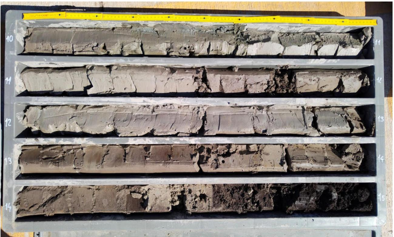
Fig. 17. Sondaggio TS21/052, 10.00-15.00 m
