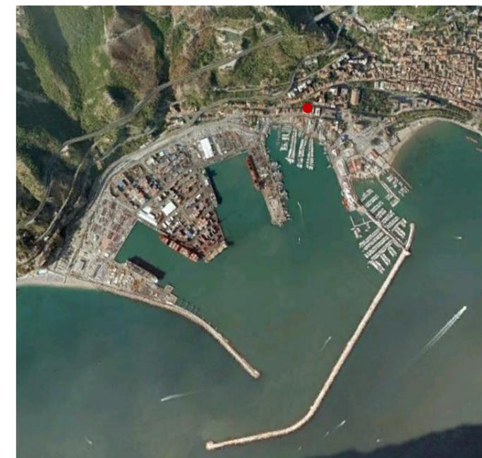
La fotosimulazione permette di valutare in che modo i due interventi atti all'allargamento dell'imboccatura, modifichino le condizioni di visibilità; si può notare come, sia l'allungamento del molo sopraflutto che la resecazione del molo sottoflutto, risultino poco invasivi per la visuale.
