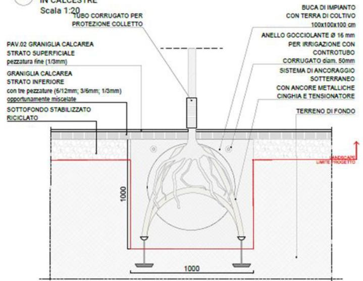
Figura 3 - Immagini a scopo illustrativo del dettaglio di impianto alberi, arbusti ed erbacee
