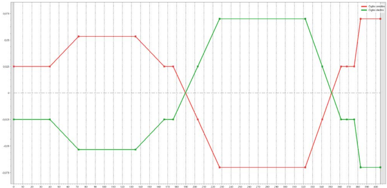
Figura 23: Andamento sopraelevazioni - Rampa semidiretta in uscita sud
