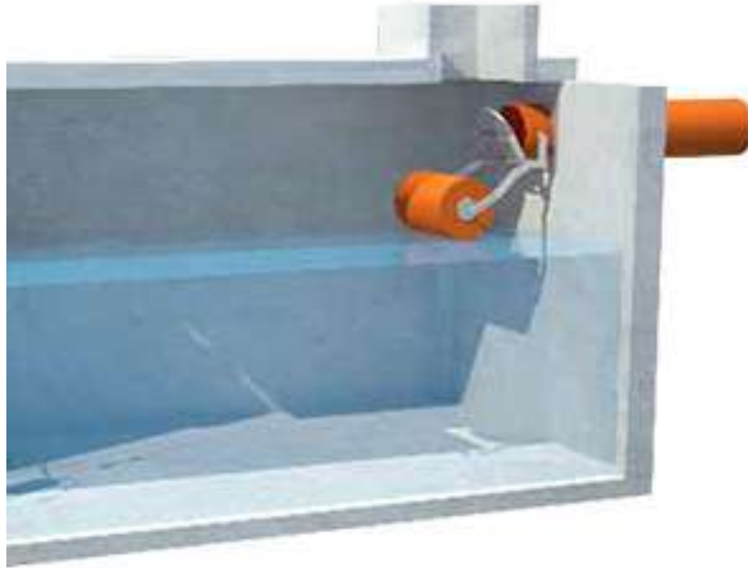
Figura 5: Schema di funzionamento della valvola a galleggiante
