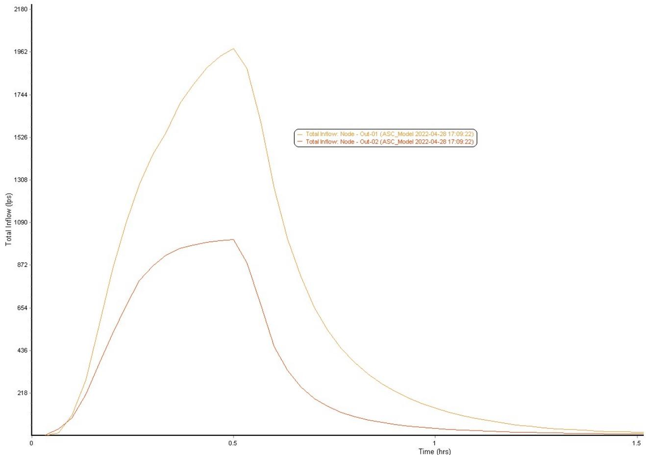
Figura 5: Idrogrammi di portata dei collettori finali, output modellazione con S&SA, pioggia  $Tr=10$ anni -  $d=30$  minuti
