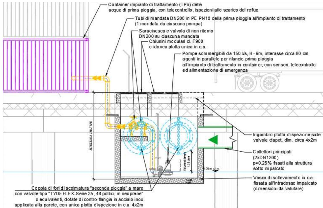
Figura 9: Sezione tipologica di sollevamento Sn verso impianto di trattamento prima pioggia in container
