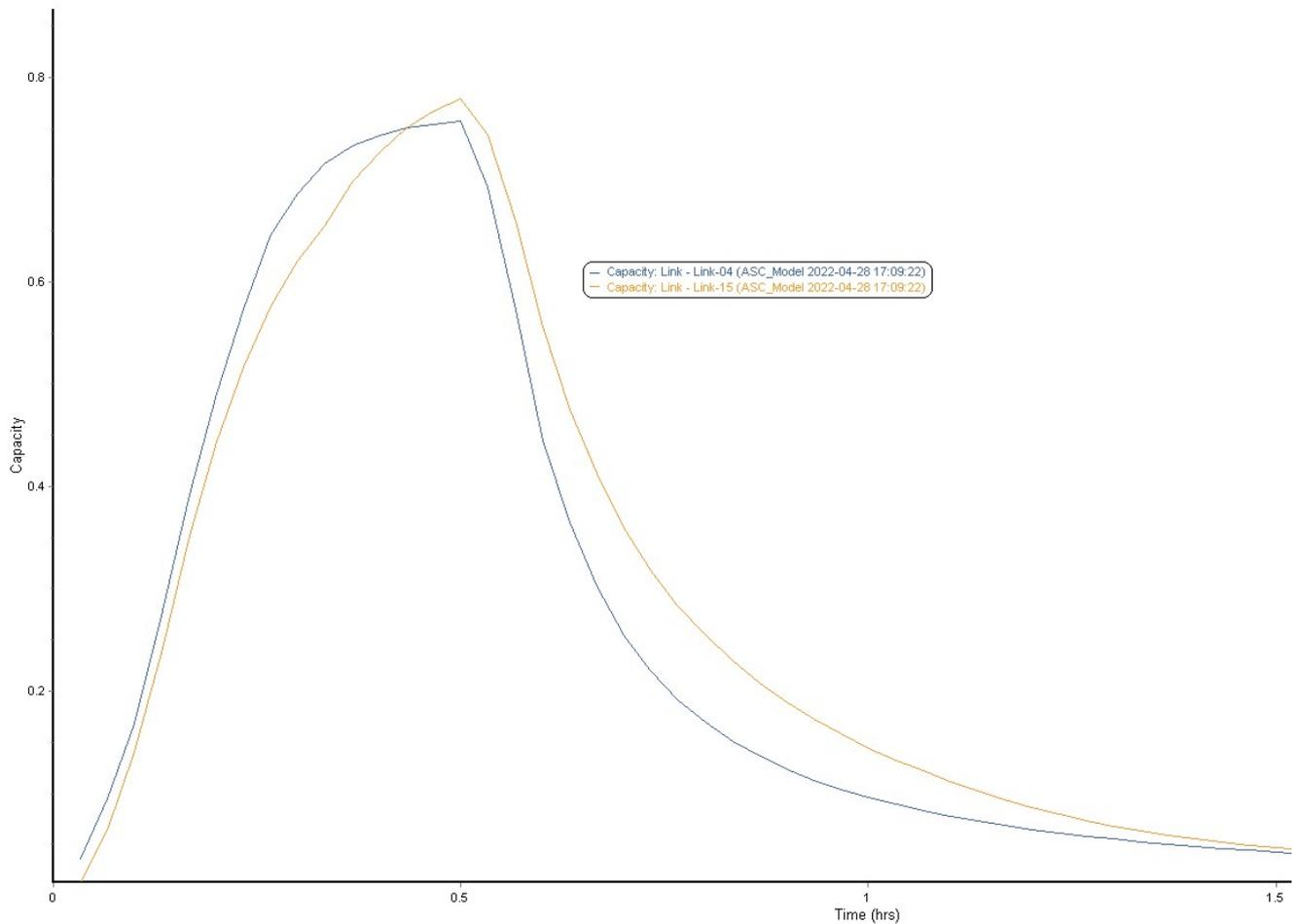
Figura 6: Capacità dei collettori finali, output modellazione con S&SA, pioggia  $Tr=10$  anni -  $d=30$  minuti
