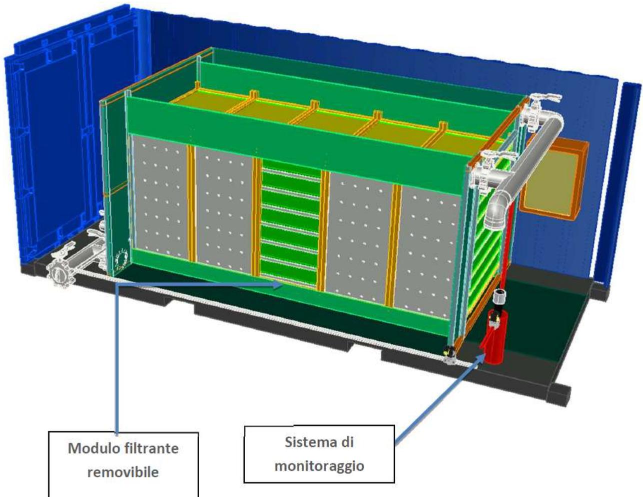
Figura 10: Esempio di impianto di trattamento in container
