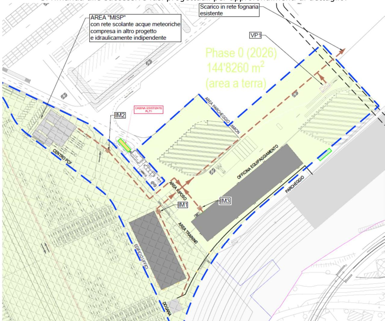
Figura 11: Planimetria di progetto rete acque nere fase 2b-aree a terra
