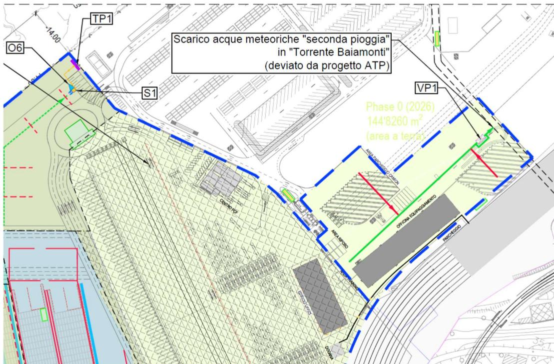
Figura 3: Planimetria di progetto rete acque meteoriche fase 2b-aree a terra
