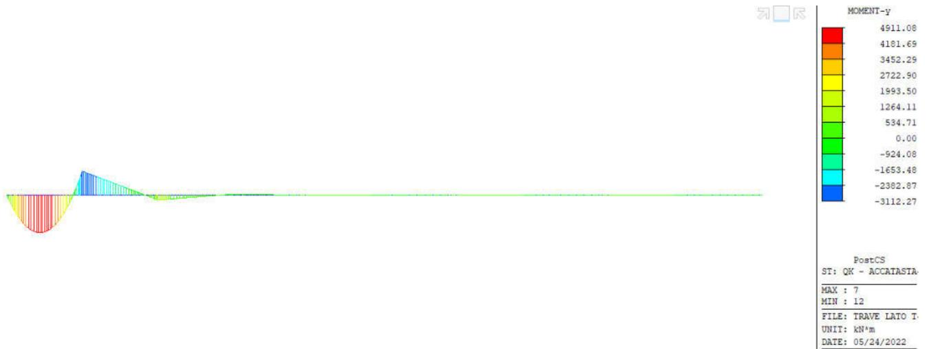
Figura 6-85: Momento flettente - Fase 3 - Container - Configurazione 1
