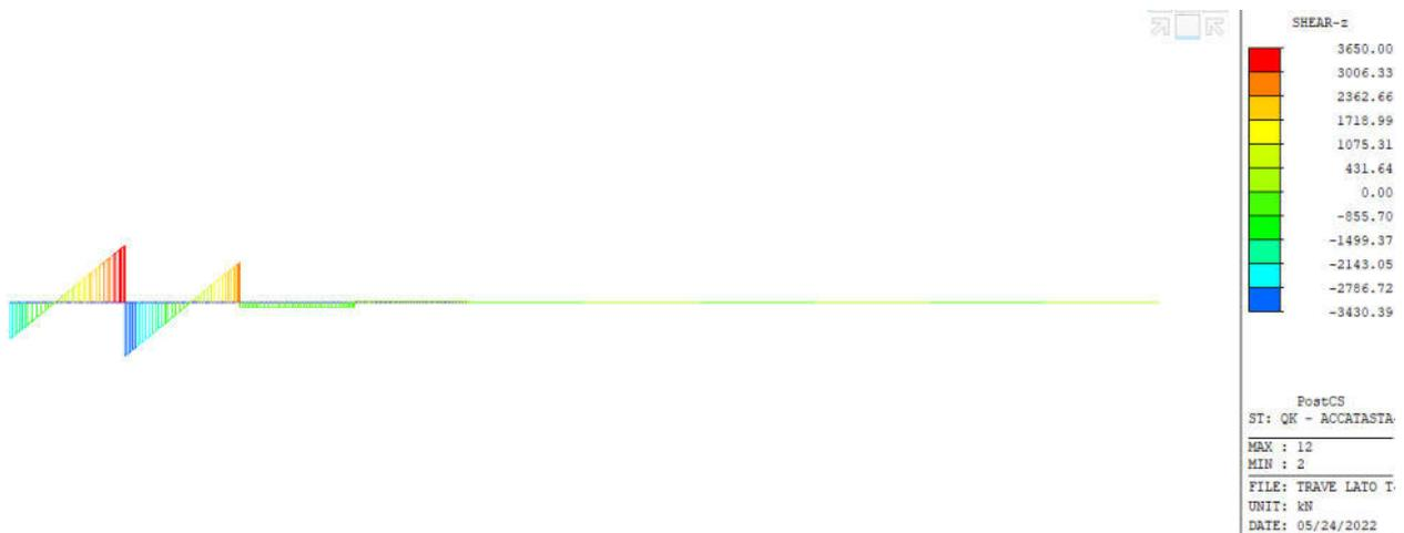
Figura 6-100: Taglio - Fase 3 - Container - Configurazione 2
