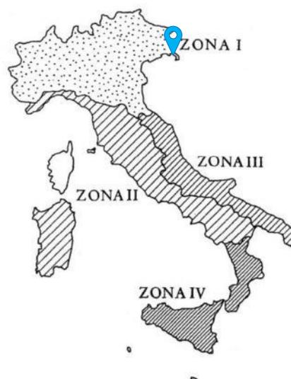
Figura 7-8: Zone per azione della temperatura
