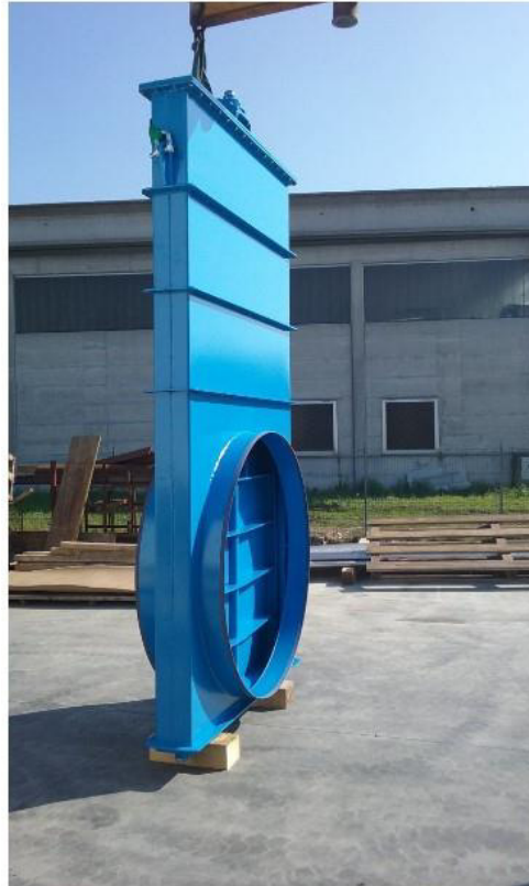
Figura 13: Esempi di paratoia di sezionamento in-line
