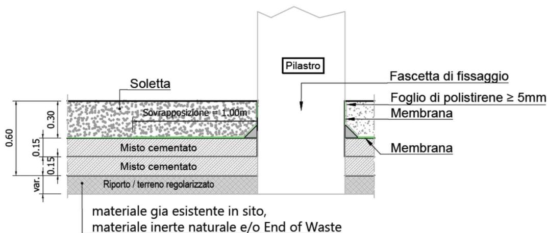
Figura 5.13: Particolare fissaggio geomembrana ai pilastri
