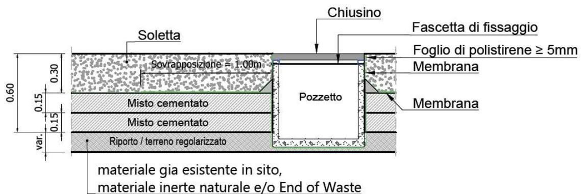
Figura 5.11: Particolare fissaggio geomembrana a pozzetti
