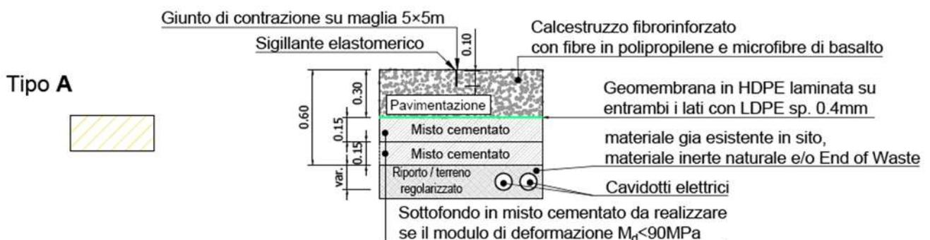
Figura 5.5: Particolare del pacchetto di pavimentazione di tipo A
