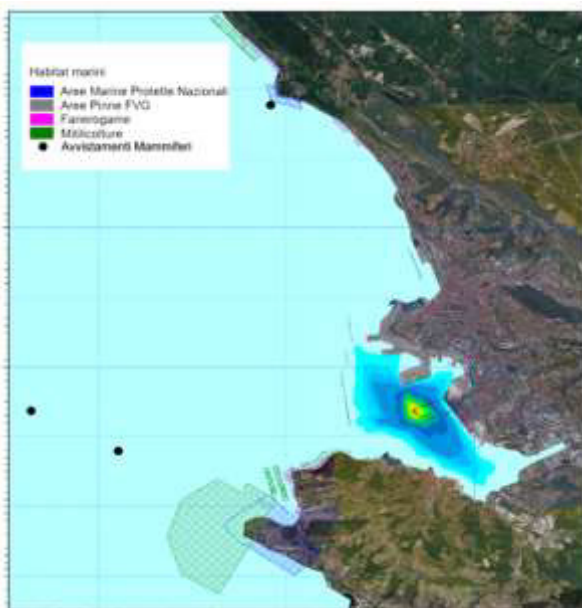
Figura 6-12: Massimi di concentrazione in superficie a seguito della realizzazione dei pali – media dei valori massimi di tutte le simulazioni effettuate (su base annuale)
