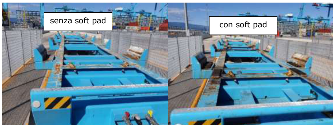
Figura 7-1: Esempio di soft pad per assorbire il rumore emesso dall'interfaccia tra rimorchio e container
