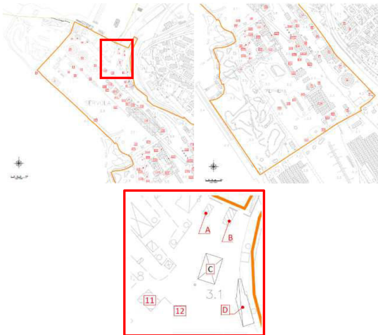
Figura 3-63 Estratto dalla tavola "PIANO DI DISMISSIONE Comprensenti anche le attività di smantellamento e demolizione dell'Area a Caldo Ferriera di Trieste", che riporta l'indicazione di tutti gli edifici da demolire. Nel riquadro rosso gli edifici mantenuti fino alla realizzazione del nuovo gate di accesso e degli altri edifici pubblici
