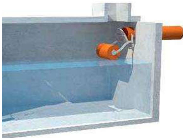
Figura 3-25 Schema di funzionamento della valvola a galleggiante
