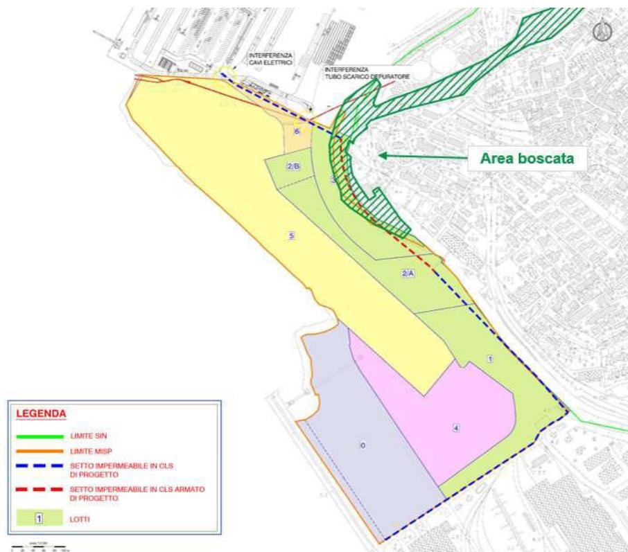
Figura 6-4. Estratto planimetria setto impermeabile con sovrapposizione area boscata.
