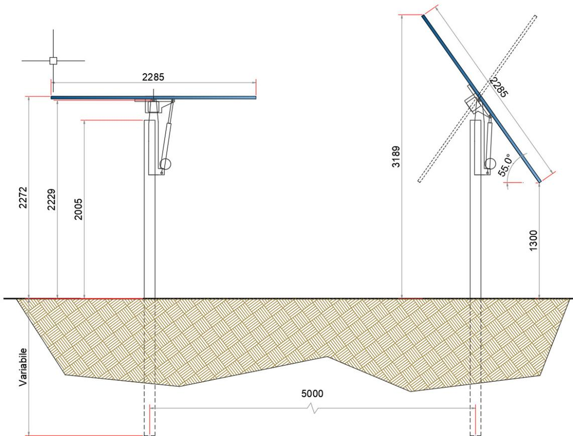
Fig. 1- Tracker - Inseguitore mono-assiale - intervalli di rotazione
