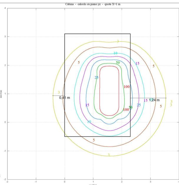
ISOLINEE INDUZIONE MAGNETICA B EMessa DALLA CABINA MT/BT DI CAMPO. OBIETTIVO DI QUALITÀ DI 3 μT RAGGIUNTO A DISTANZA < DI 1,38 METRI DAL PERIMETRO OCCUPATO DAGLI IMPIANTI. LA DISTANZA DI PRIMA APPROSSIMAZIONE (DPA) SI ASSUME PARI A 2 m.
