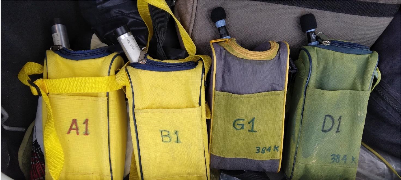
Figura 8. L'attrezzatura di rilevamento bioacustico utilizzata per le conoscenze sulla Chiroterofauna nell'Area di studio (Monitoraggio V.Ferri, 2022). Si tratta dei bat-detector Dodotronic Ultramic 384K, utilizzati con programmazione automatica presso stazioni di rilevamento fisso.
