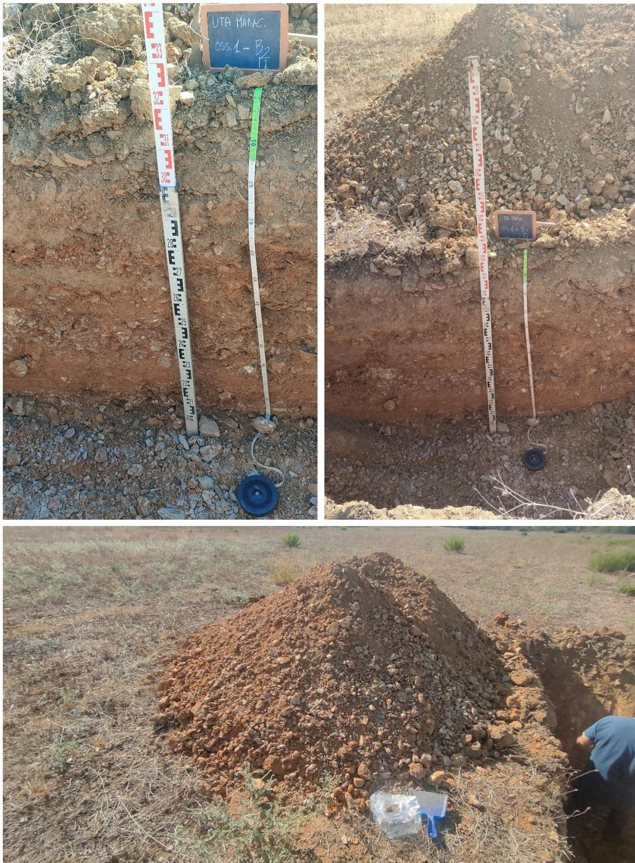
**Figura 2.10 – Materiali estratti da un livello detritico intercettato nel pozzetto realizzato nell’ambito dell’unità colluviale LL\_B.**
