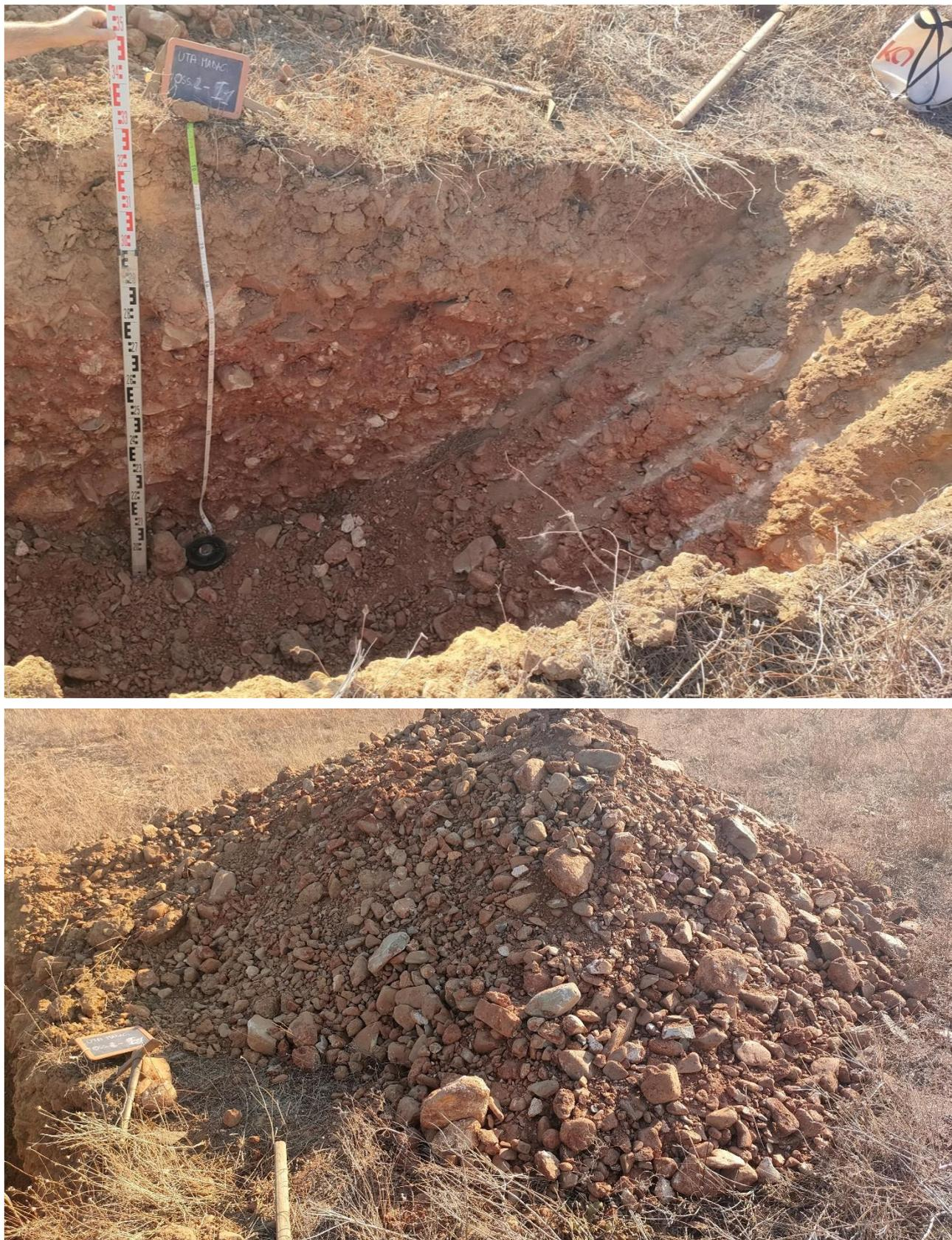
**Figura 2.11 – Stratigrafia e materiali estratti dal pozzetto realizzato nell’unità alluvionale LL\_C.**
