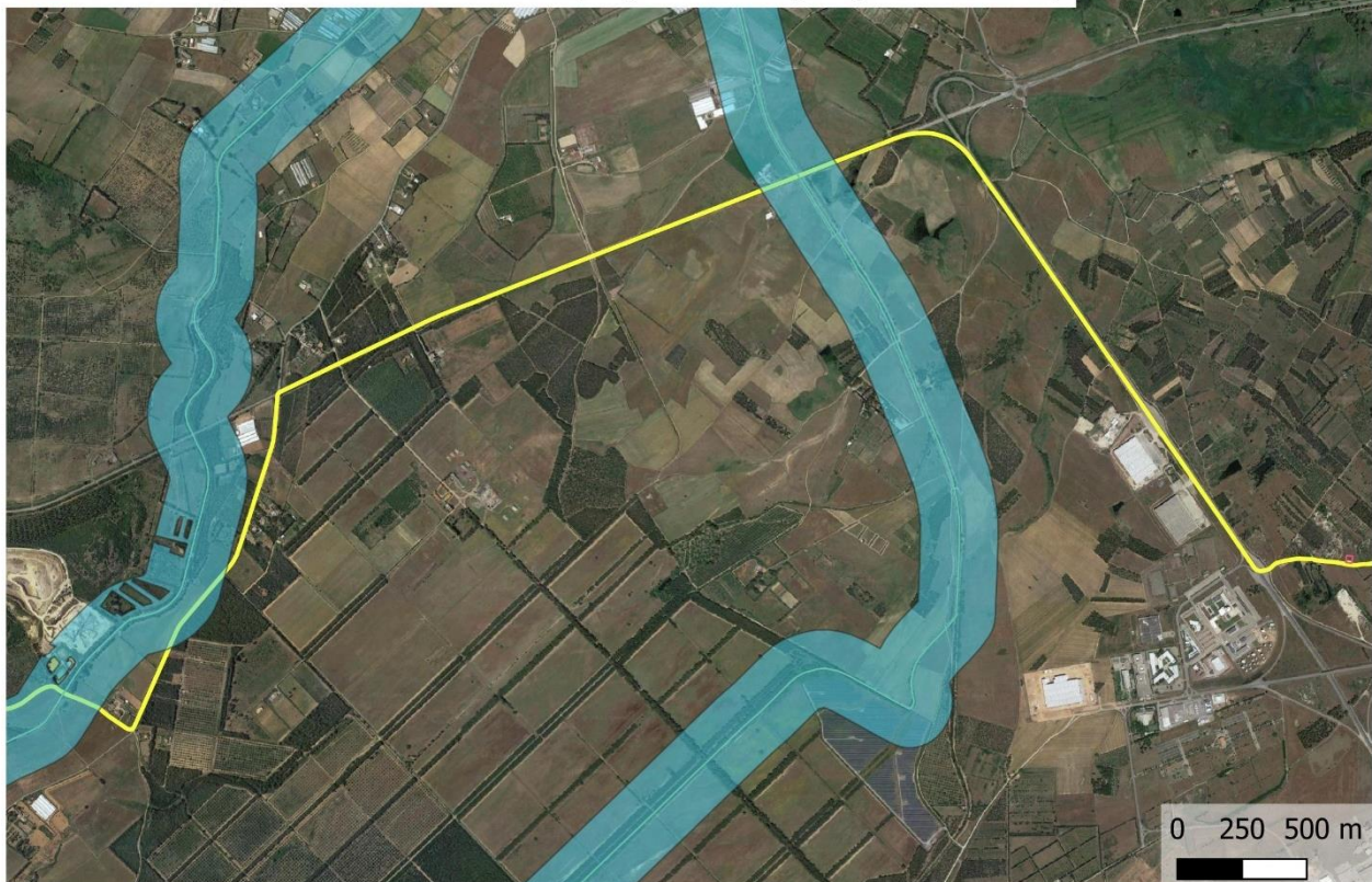
Figura 6.4: Sovrapposizione del cavidotto a 36 kV interrato e impostato su viabilità esistente con “Fiumi, torrenti e corsi d'acqua iscritti negli elenchi del testo unico delle disposizioni di legge sulle acque ed impianti elettrici, approvato con regio decreto 11 dicembre 1933, n. 1775, e le relative sponde o piedi degli argini per una fascia di 150 metri ciascuna” (Art. 142 comma 1 lettera c)
