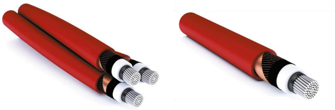
**Figura 5.8 – Cavo 36 kV di tipo elicordato ARG7H1RX e non elicordato ARG7H1R**
