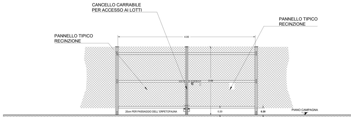
RECINZIONE METALLICA A SEMPLICE TORSIONE H=2.00m, MAGLIA QUADRATA 50x50mm IN FILO CON COPERTURA IN LEGA ZINCO-ALLUMINIO Ø 3mm
