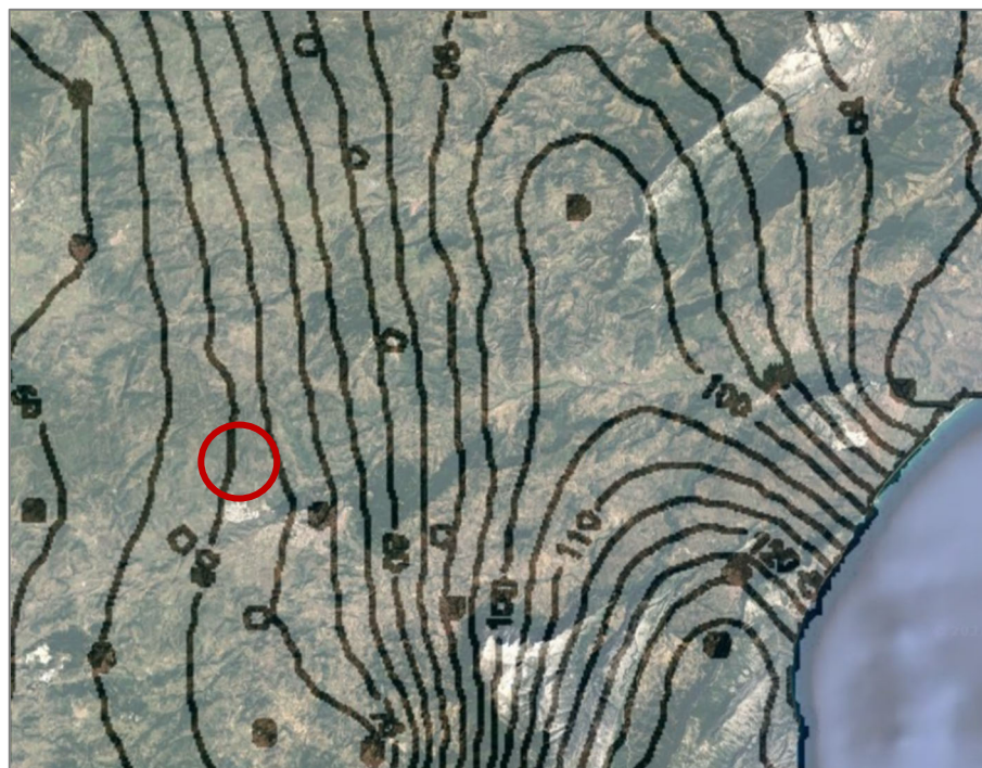
Figura 3-5: Dettaglio della carta delle isoiete per identificare la pioggia indice giornaliera espressa in [mm] (il cerchio in rosso scuro evidenzia l'area di studio)
