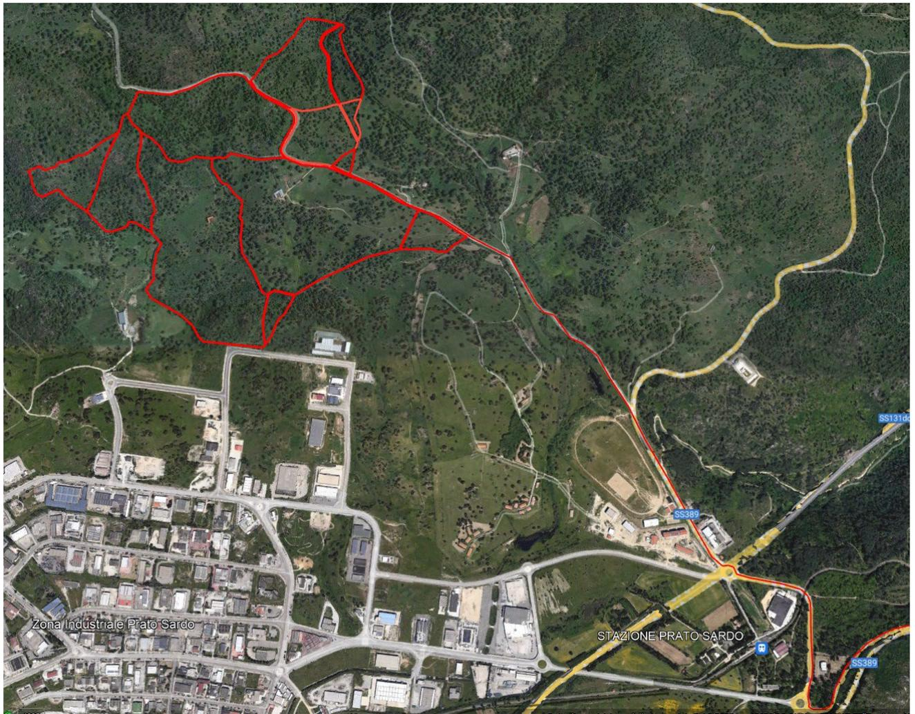
**Figura 3.3** Dettaglio dell'area di installazione dei pannelli e tracciato del cavidotto. La viabilità principale di accesso è la S.S. 389, da cui si diparte una viabilità secondaria di accesso ai fondi agricoli
