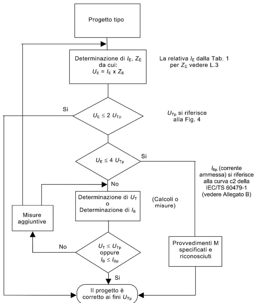
**Figura 4 – Progetto di un impianto di terra (rif. CEI EN 50522 / CEI 99-3)**
