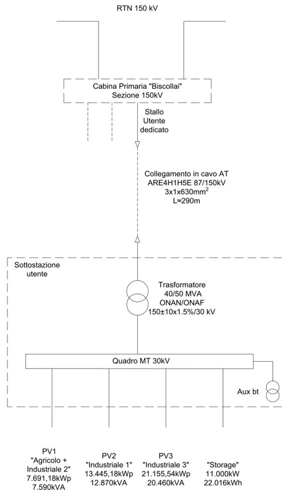
**Figura 2 - Schema di principio di connessione tra la SSE Utente e la RTN**
