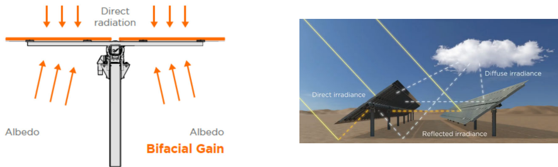
Figura 2.3: esempi di inseguitori monoassiali con moduli bifacciali
