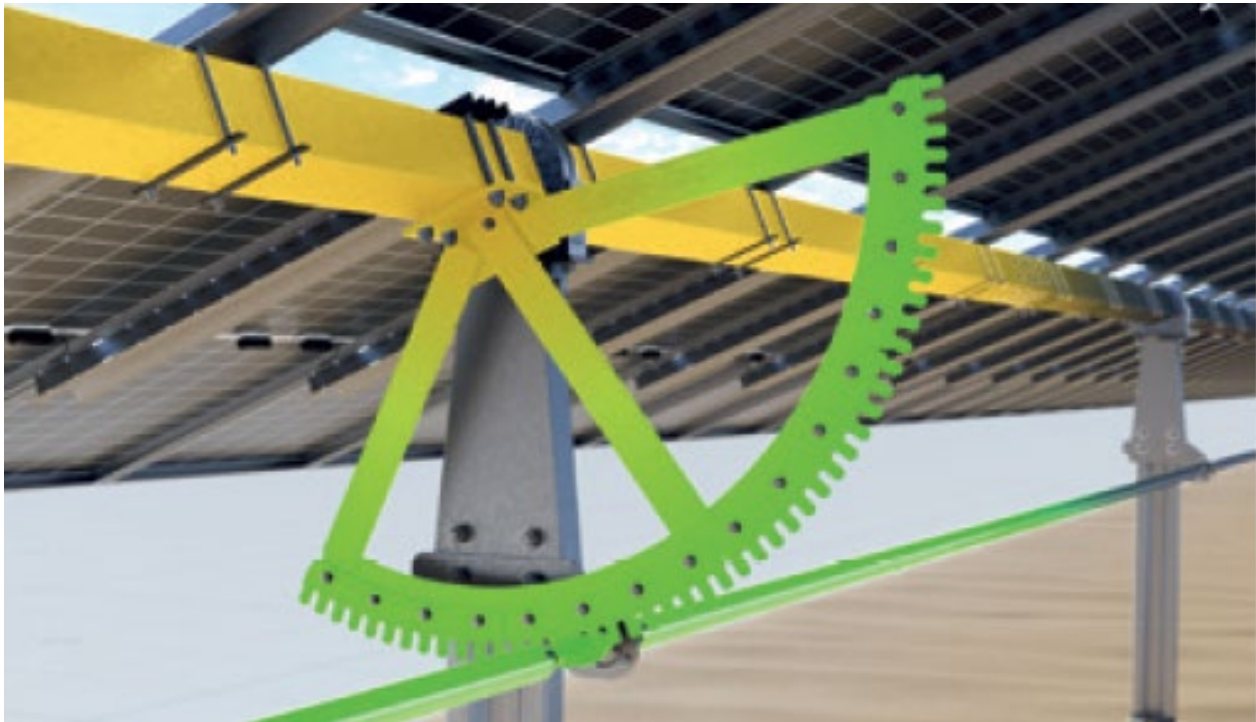
Dettaglio movimentazione con inseguitore monoassiale Est-Ovest
