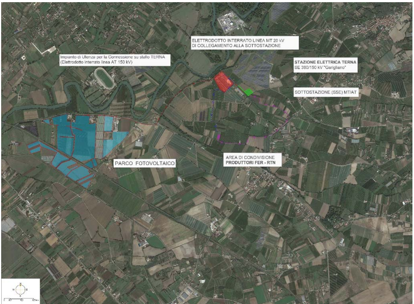
Ortofoto con indicazione del Parco Fotovoltaico e del cavo di connessione alla Sottostazione Elettrica d’Utenza (SSE) di proprietà del Produttore.
