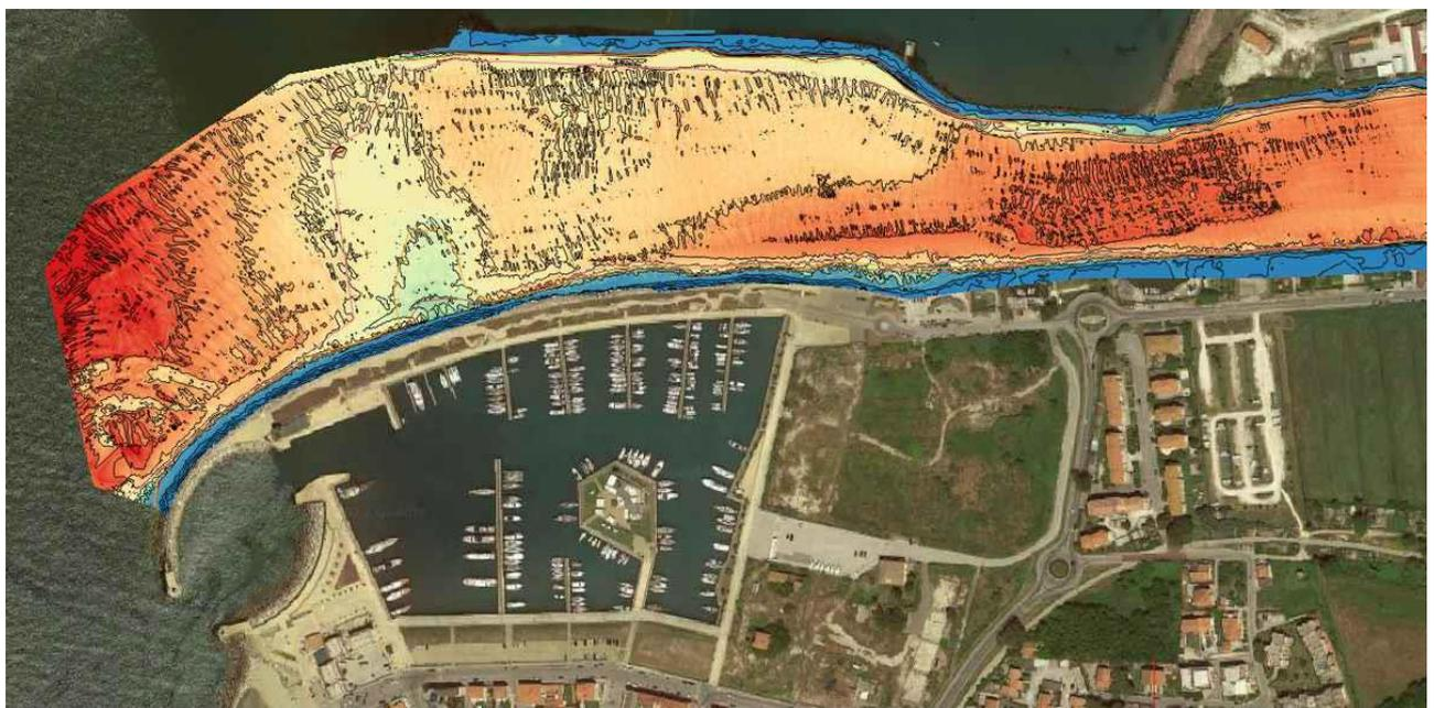
Figura 29: fiume Arno, rilievo batimetrico della foce eseguito nel febbraio 2022.
