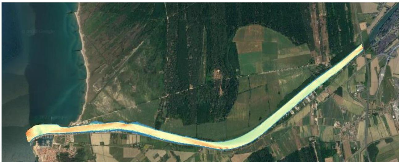
Figura 32: restituzione del rilievo batimetrico tramite GIS, primo tratto (valle).
