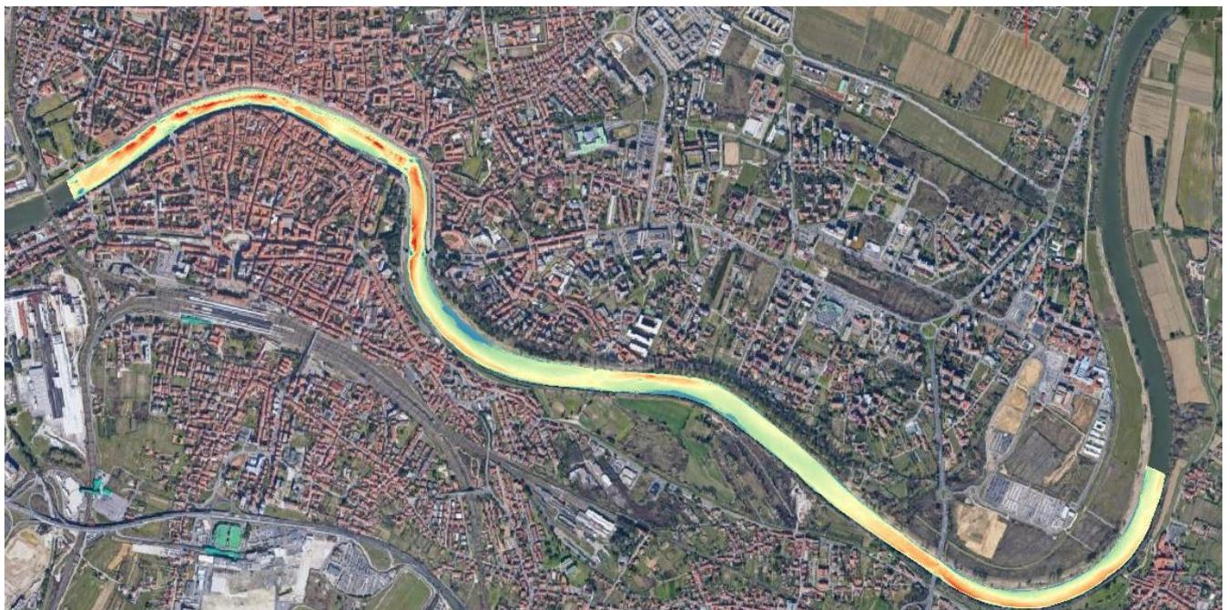
Figura 34: restituzione del rilievo batimetrico tramite GIS, terzo tratto (monte).
