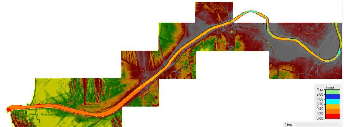
Figura 43: velocità per  $Q=200$  mc/s.
