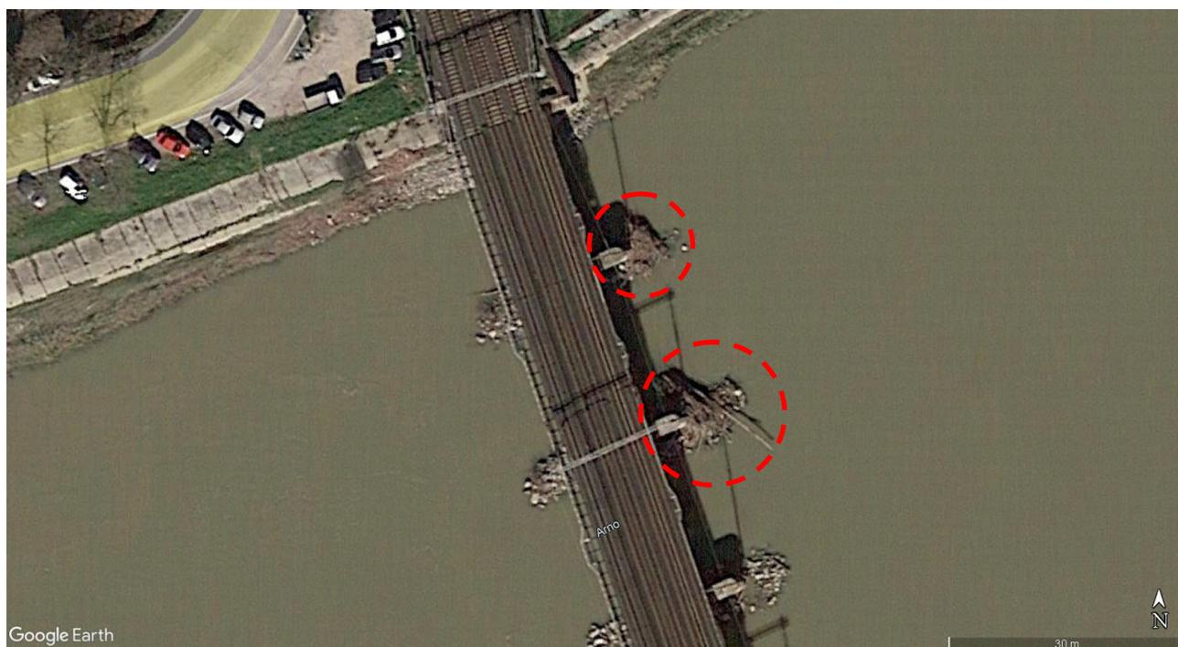
Figura 61: particolare della foto precedente relativa all'accumulo di materiale flottante in corrispondenza dei fronti delle due pile in sponda destra [fonte Google Earth ®].
