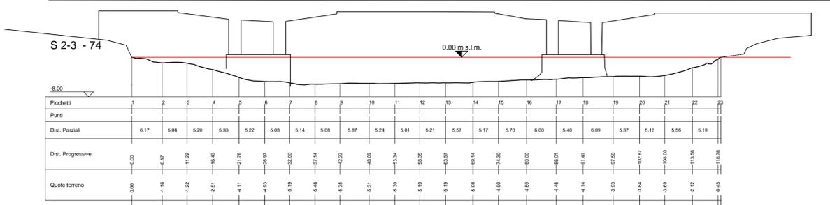
SEZIONE A VALLE DEL PONTE (con proiezione del manufatto alle spalle)
