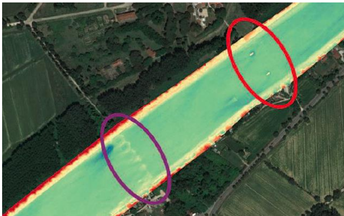
Figura 3.12 - Pile dell'ex passerella dell'Acquedotto (cerchiati in rosso) e relativi residui formati a valle (cerchiati in magenta)
