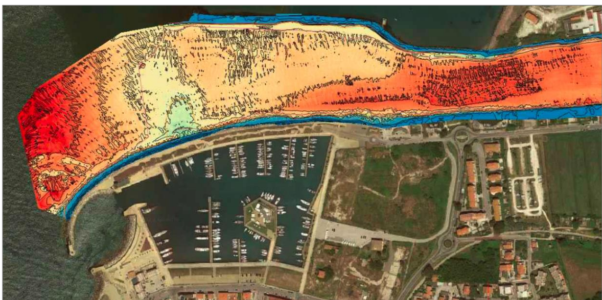
Figura 3.10 - Fiume Arno, rilievo batimetrico della foce eseguito nel febbraio 2022
