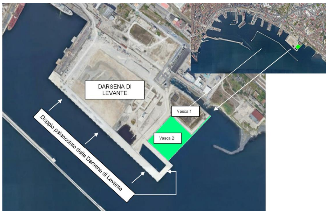
Figura 2-3: Colmata del Vigliena costituita dalla Vasca 1 allo stato attuale e Vasca 2 in verde e Darsena di Levante
