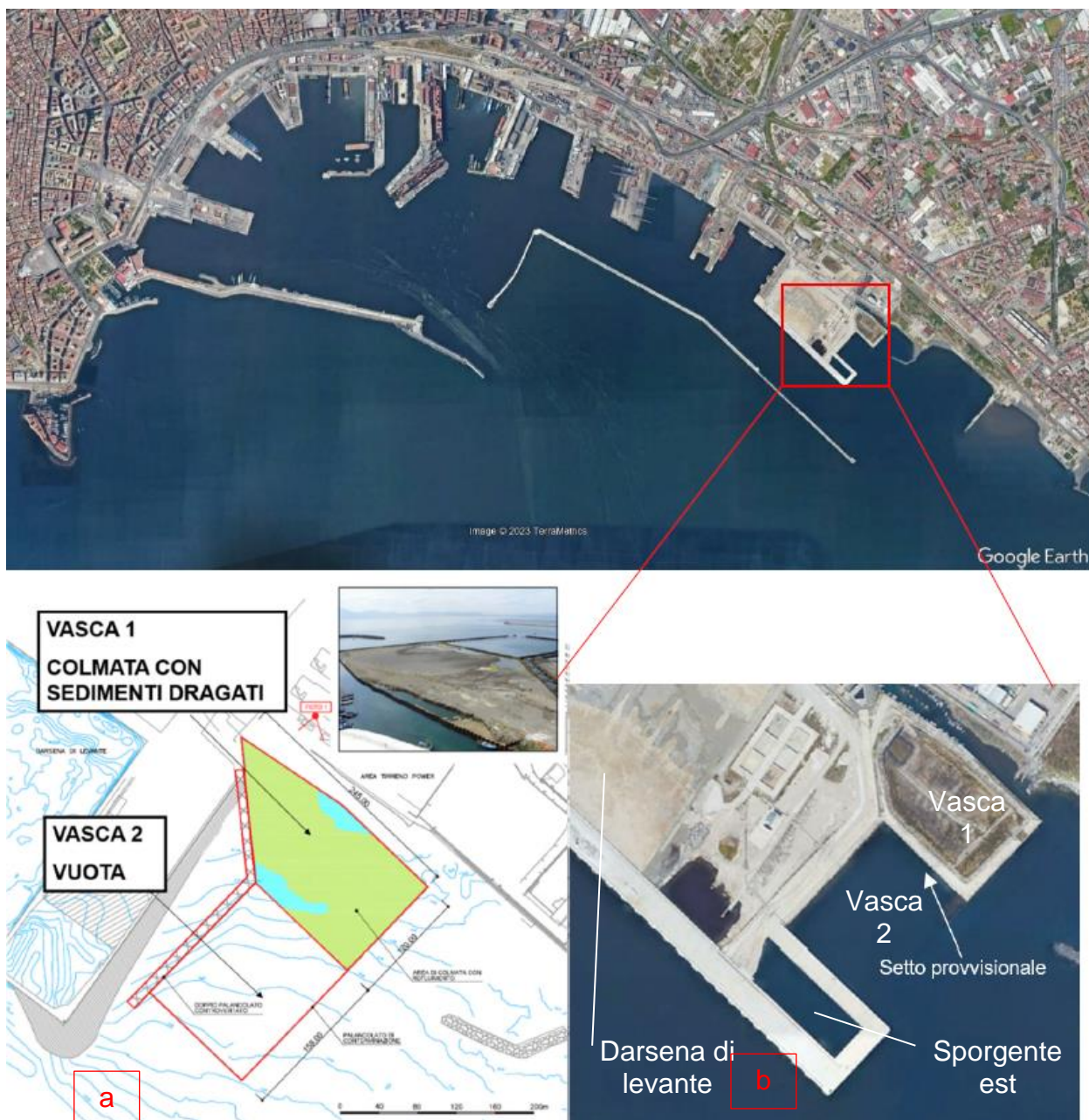
Figura 2-1 Cassa di colmata del Vigliena realizzata dal commissario per le Bonifiche e Rifiuti nel 2009, suddivisa in Vasca 1 e Vasca 2.
