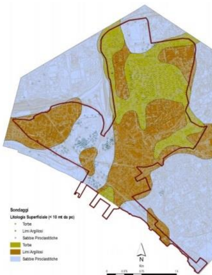
Figura 5-22 - Limiti stratigrafici superficiali (da interventi di messa in sicurezza e bonifica della falda del S.I.N. orientale di Napoli)
