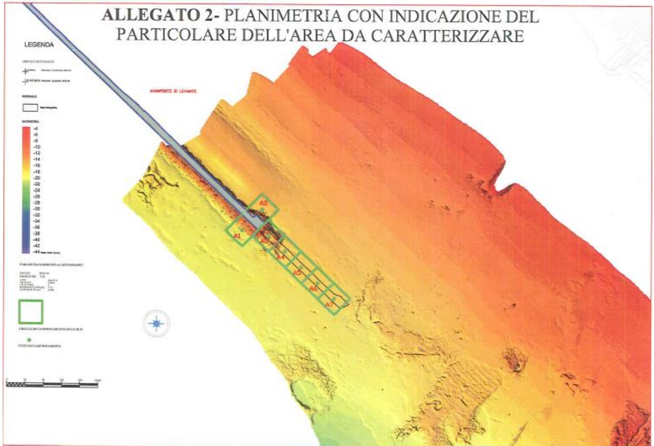
Figura 13: Porto di Napoli – Rilievo batimetrico 2020 con ubicazione maglie di caratterizzazione prolungamento diga
