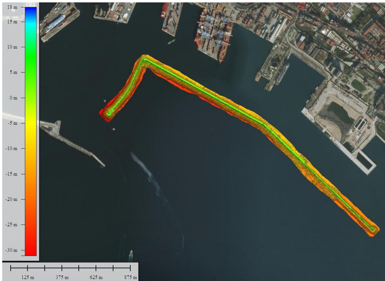
Figura 4 - DTM della diga Duca d'Aosta e dell'antemurale Thaon de Revel
