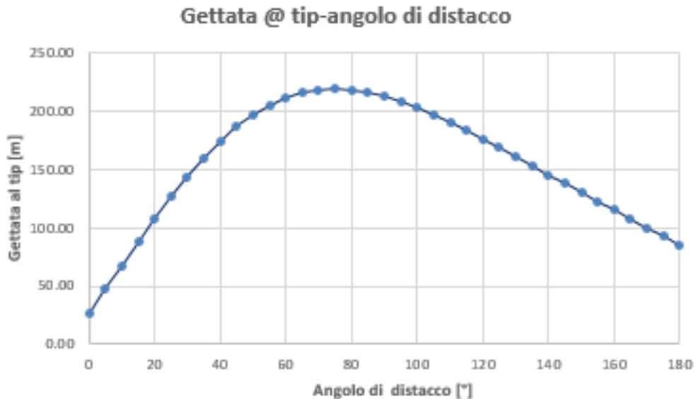
Figura 5-3: Gittata al tip vs. angolo di distacco
