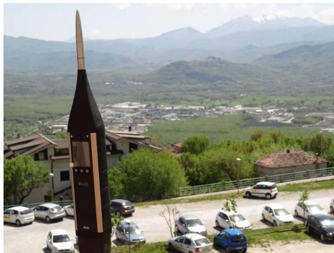
**Figura 4-1: Analizzatore in frequenza DUO**
