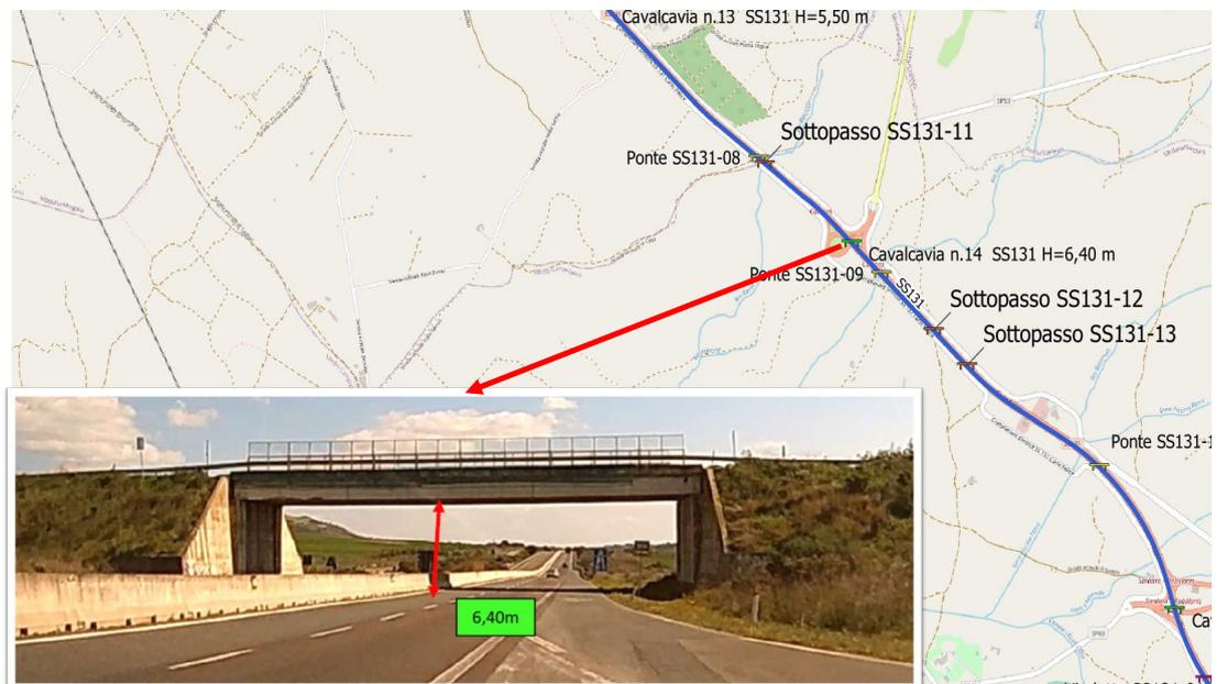
**Figura 5-37 Elemento critico Cavalcavia SS131-14.**
