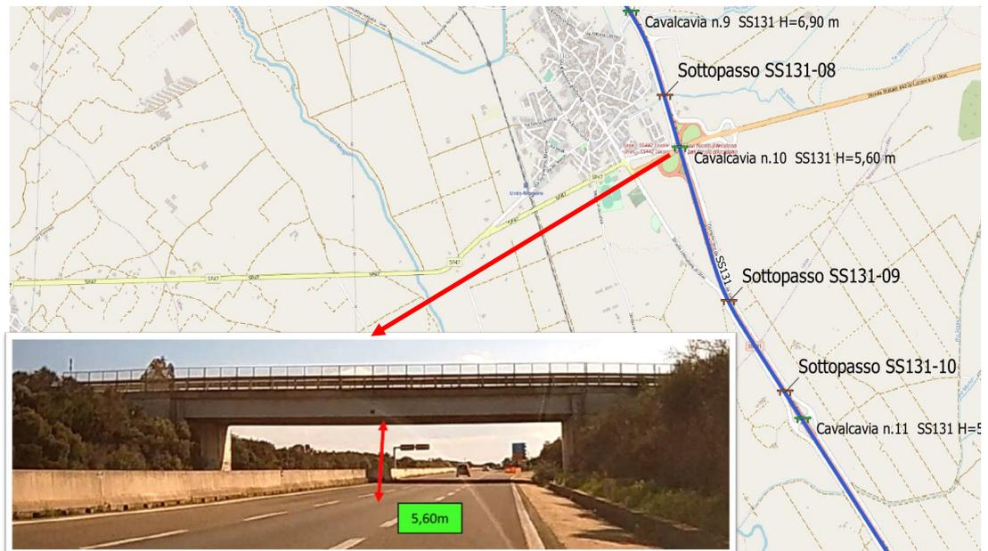
**Figura 5-33 Elemento critico Cavalcavia SS131-10.**
