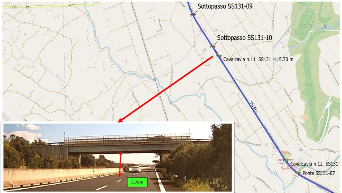
Figura 5-34 Elemento critico Cavalcavia SS131-11.
