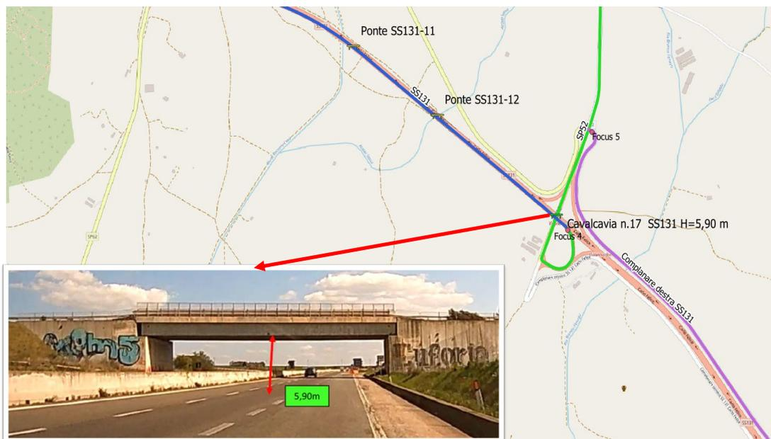
**Figura 5-40 Elemento critico Cavalcavia SS131-17.**
