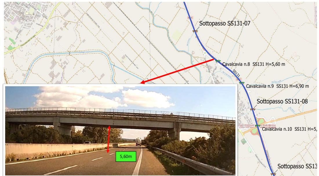
**Figura 5-31 Elemento critico Cavalcavia SS131-08.**
