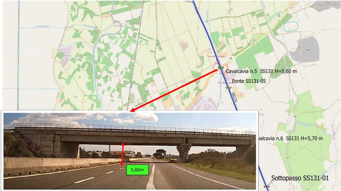
Figura 5-28 Elemento critico Cavalcavia SS131-05.
