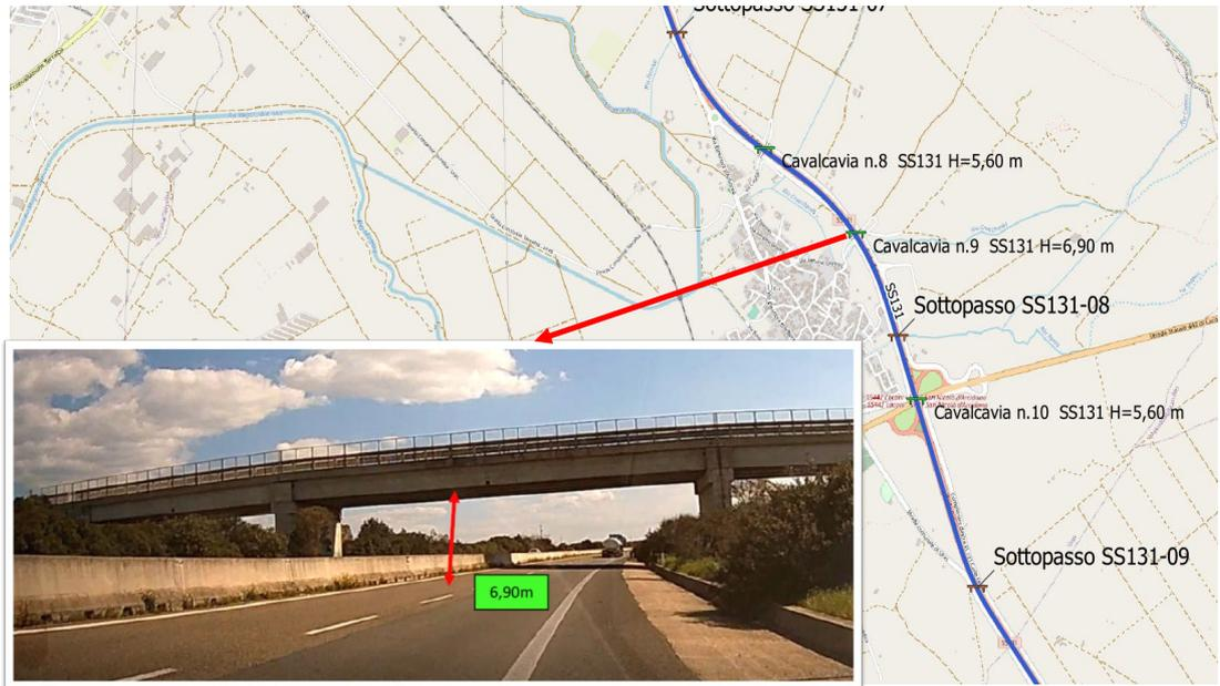
**Figura 5-32 Elemento critico Cavalcavia SS131-09.**
