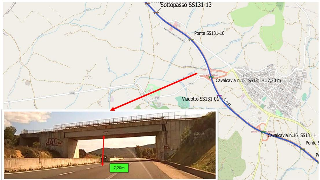
**Figura 5-38 Elemento critico Cavalcavia SS131-15.**
