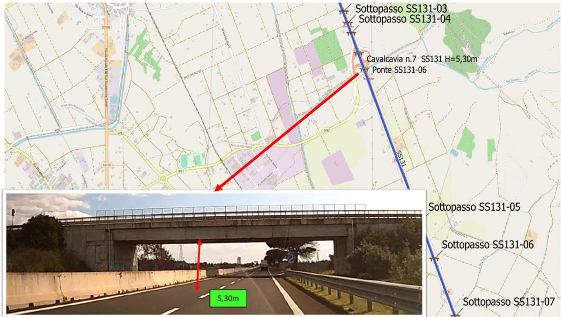
**Figura 5-30 Elemento critico Cavalcavia SS131-07.**
