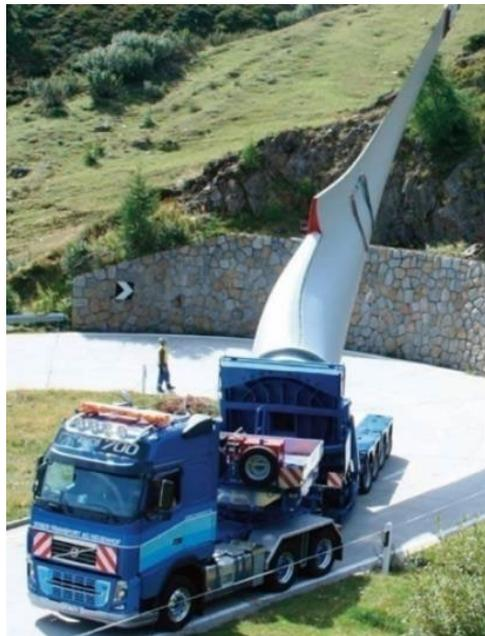
Figura 3-3 Esempio di blade lifter
