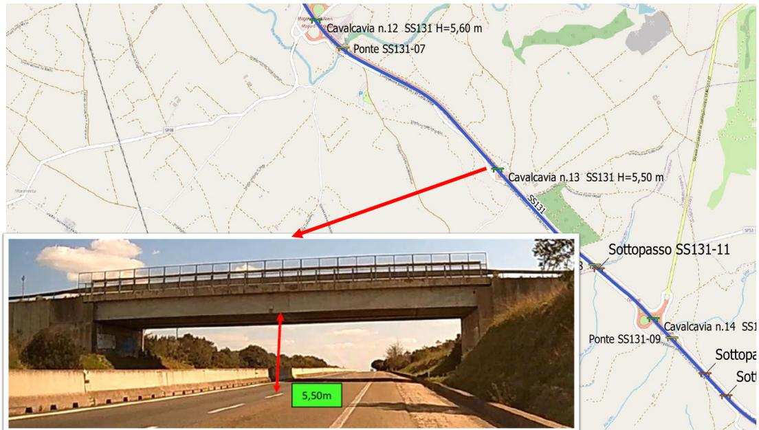
**Figura 5-36 Elemento critico Cavalcavia SS131-13.**
