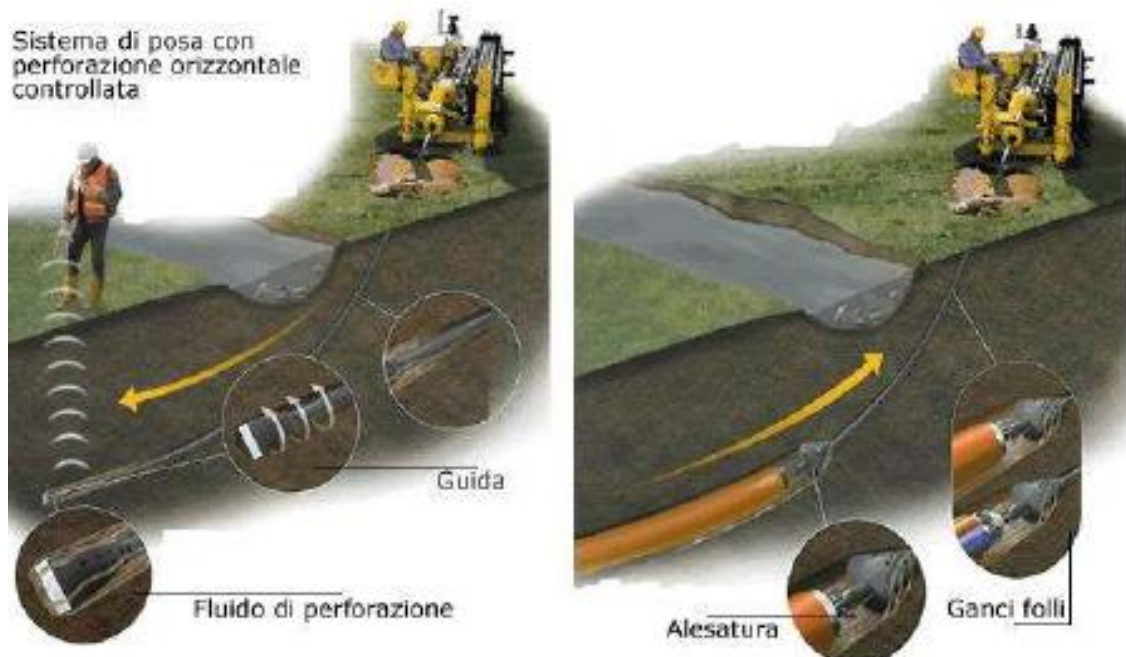
Posa in opera tubazione con trivellazione teleguidata
