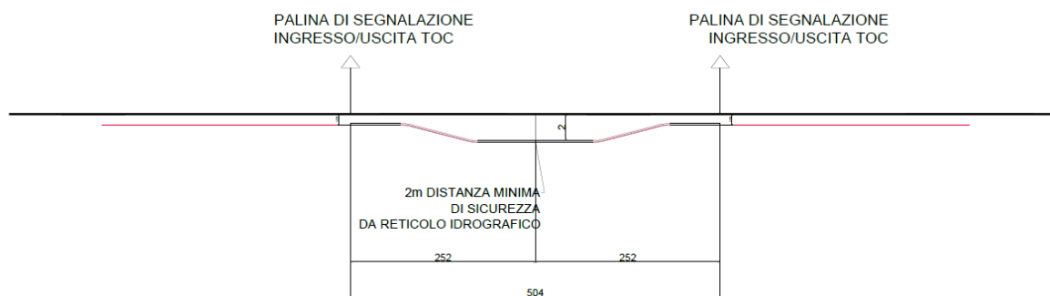
Sezione - Superamento interferenza in T.O.C.
