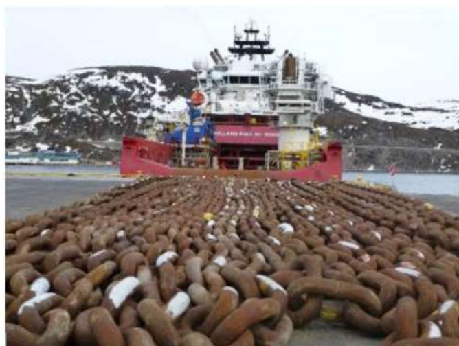
Figura 5-6 Tipici elementi di ormeggio stivati a bordo di una nave d'installazione
