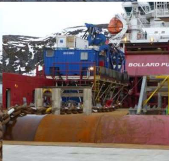
Figura 5-6 Tipici elementi di ormeggio stivati a bordo di una nave d'installazione
