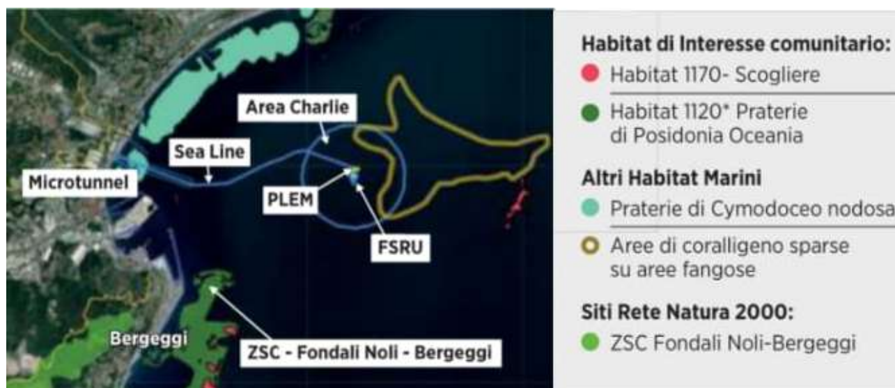
FIGURA 2 FRSU E LINEA COLLEGAMENTO A TERRA
