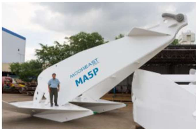
Figura 5-1 Configurazione tipica di ancore a trascinamento
